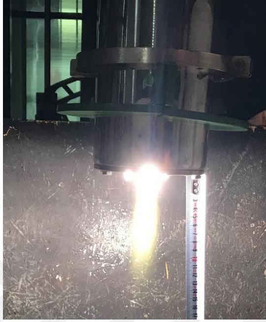
Şekil 22. Kuru hava-argon-azot gazı kullanılması sonucu oluşan plazma alev boyu.
