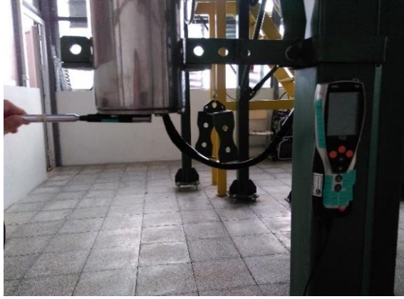
Şekil 14. Kuru hava çıkış hızının ölçülmesi.
