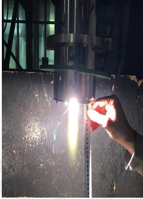
Şekil 19. Kuru hava ile oluşturulan plazma alev boyunun ölçülmesi.
