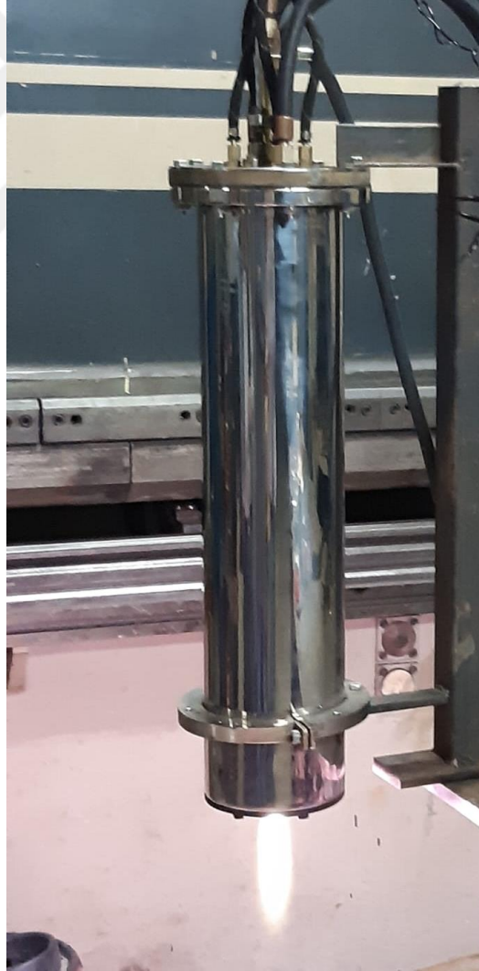
Şekil 4. Doğru akım ark plazma gazlaştırma torçu test çalışması.
