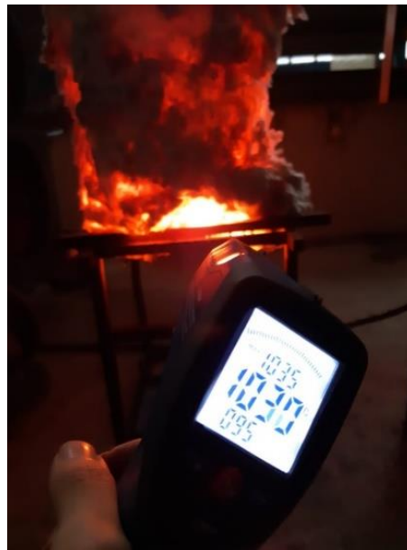
Şekil 8. Hücre üzerinde sıcaklık ölçümü.
