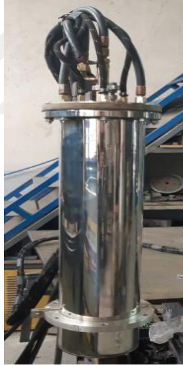
Şekil 2. Doğru akım ark plazma gazlaştırma torçu montaj görünümü.
