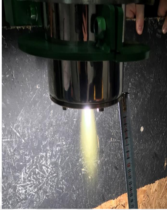
Şekil 21. Kuru hava-azot gazı kullanılması sonucu oluşan plazma alev boyu.
