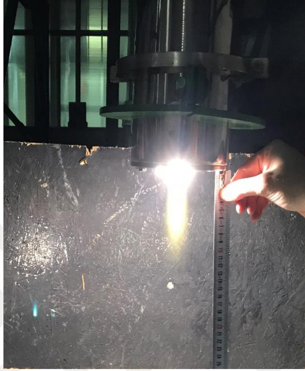
Şekil 20. Kuru hava-argon gazı kullanılması sonucu oluşan plazma alev boyu.
