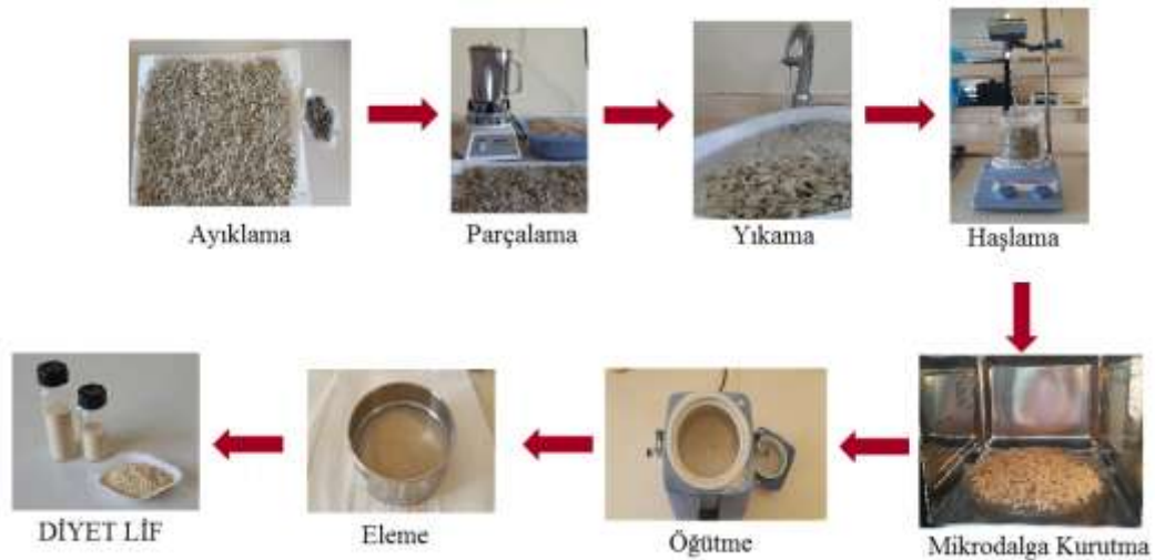
Şekil 2.4. Mikrodalga kurutma yöntemi ile şeker pancarı posasından diyet gıda lifi üretim şeması
