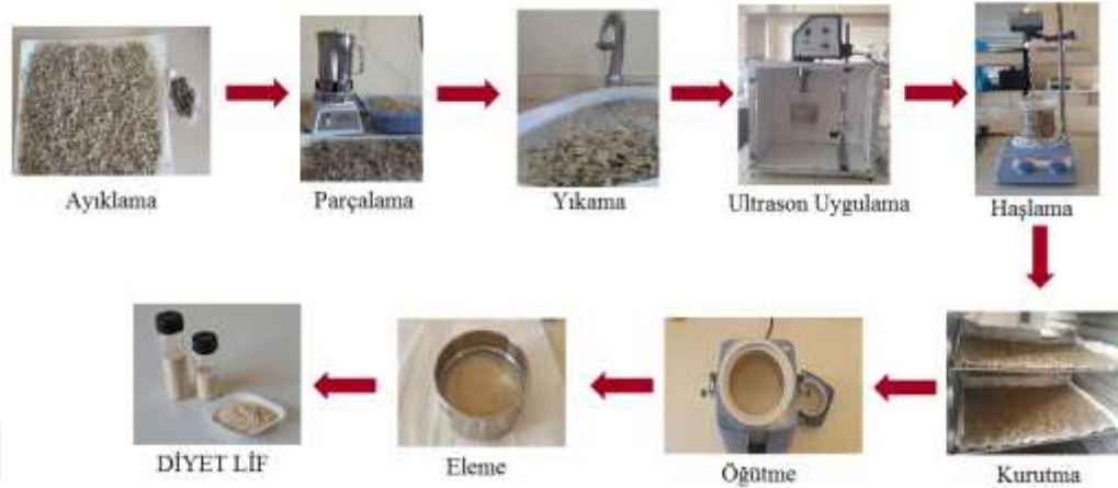
Şekil 2.3. Ultrason ön uygulama ile şeker pancarı posasından diyet gıda lifi üretim şeması
