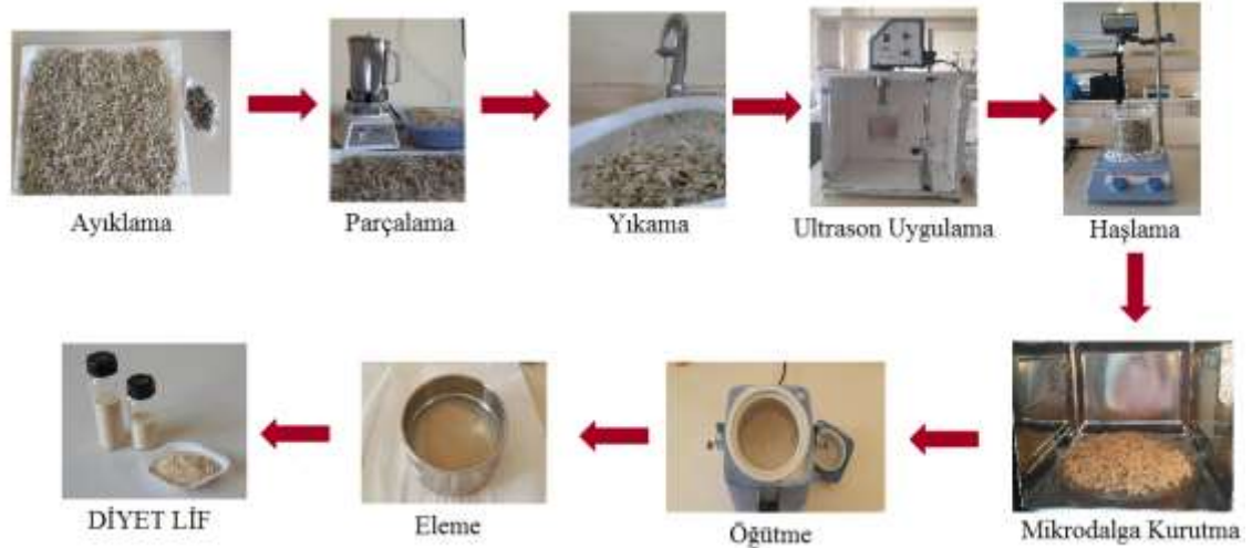
Şekil 2.5. Ultrason ön uygulama ve mikrodalga kurutma yöntemleri ile şeker pancarı posasından diyet gıda lifi üretim şeması
