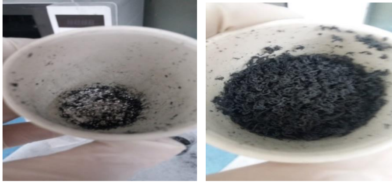
Şekil 4.3. Genişletilebilir grafit mikrodalga fırın öncesi ve sonrası görüntüsü
