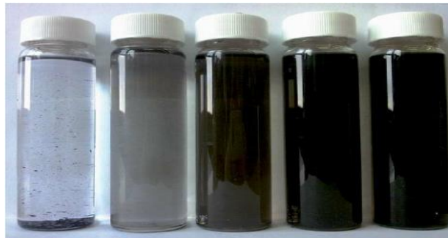
Şekil 5.1. Soldan sağa sırası ile 1,3,7,11 ve 13 saat sonikasyon sonrası karbon nanoakışkan
