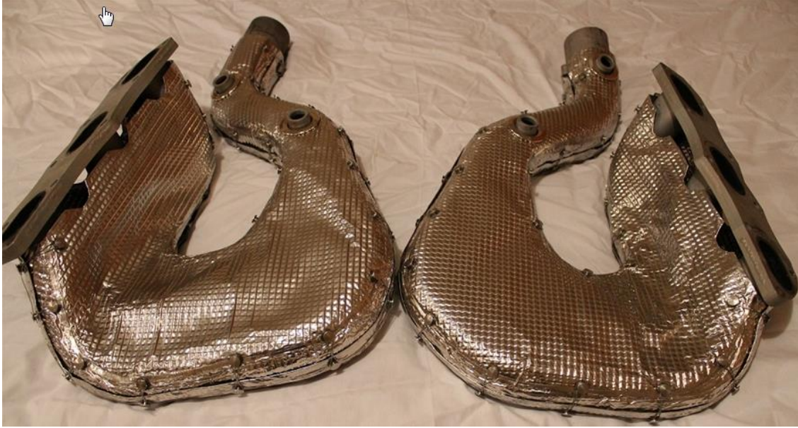
Şekil 4.6. Egzoz manifoldu üzerine sandviç kompozit panel uygulaması (Anonim,2018)
