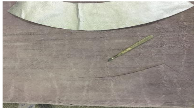
Şekil 8.1. Aerogel battaniyenin patrona göre kesilmesi
