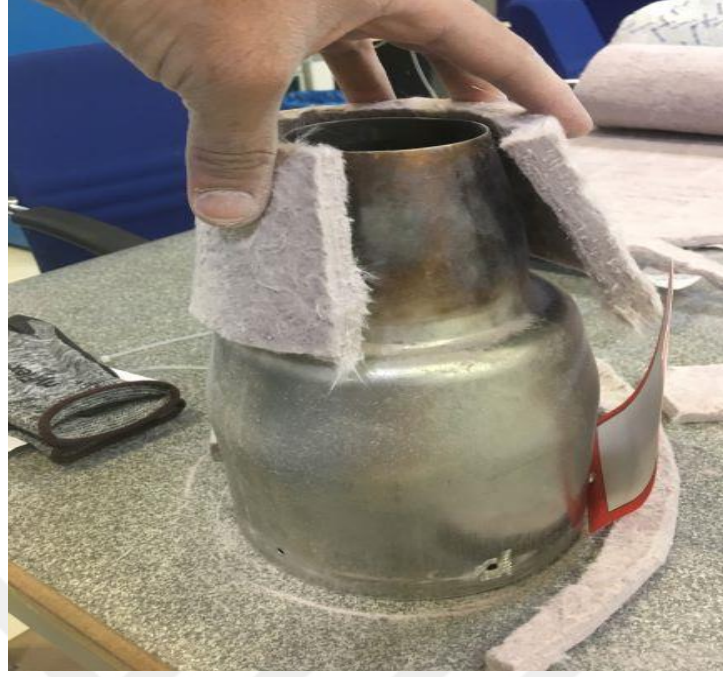
Şekil 8.7. Egzoz Lülesi etrafında ölçünün doğrulanması
