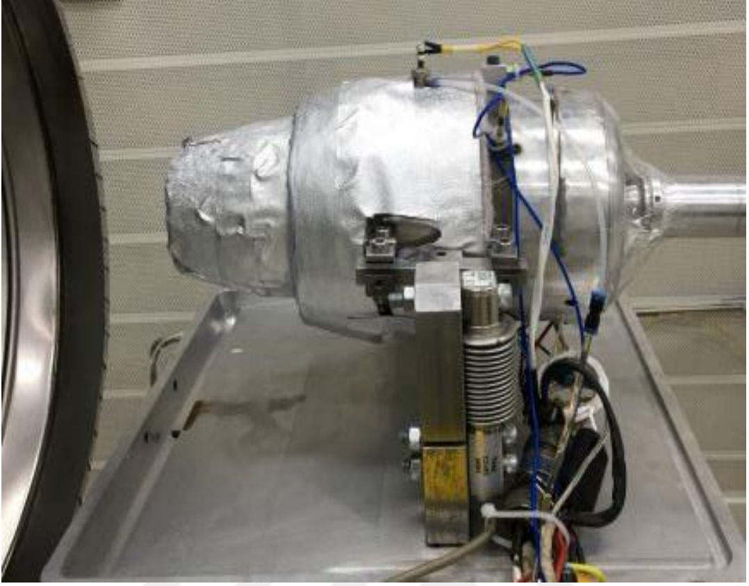
Şekil 8.15. Termal Yalıtımlı Motor soldan görünüş
