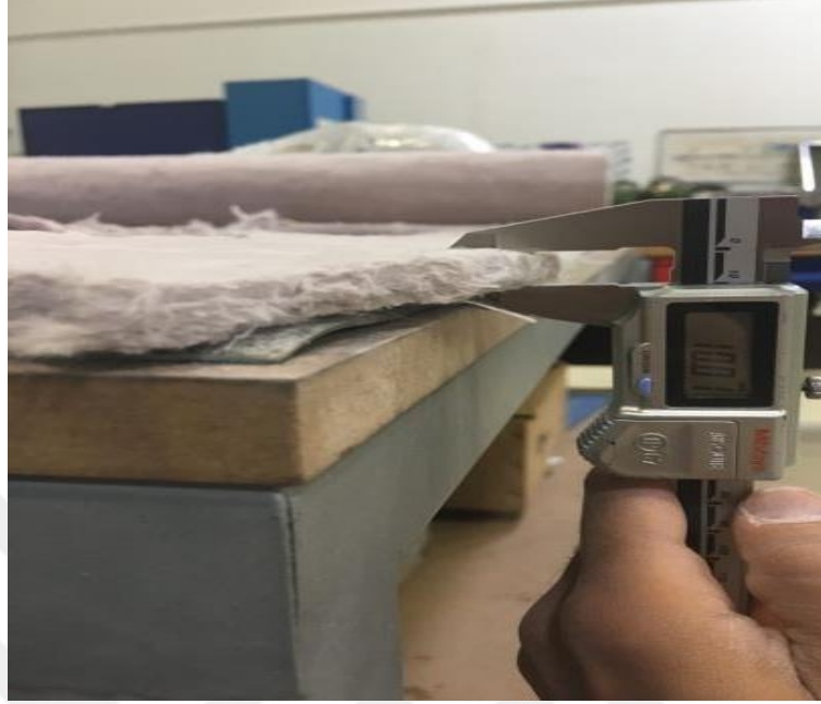
Şekil 8.5. 10 mm kalınlıktaki aerogel katmanının dijital kumpasla ölçümü
