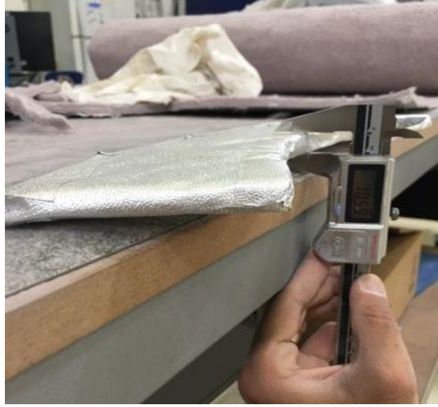
Şekil 8.12. 10 mm kalınlıklı aerogel tabakalı sandviç panelin toplam kalınlığı
