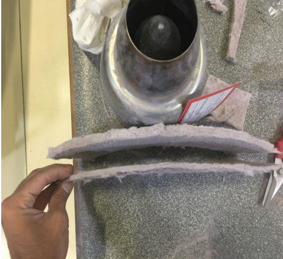
Şekil 8.4 10 mm ve 5 mm kalınlıklı battanilerin hazırlanması
