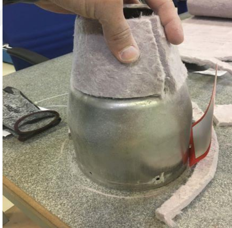
Şekil 8.8. Egzoz Lülesi etrafında ölçünün doğrulanması
