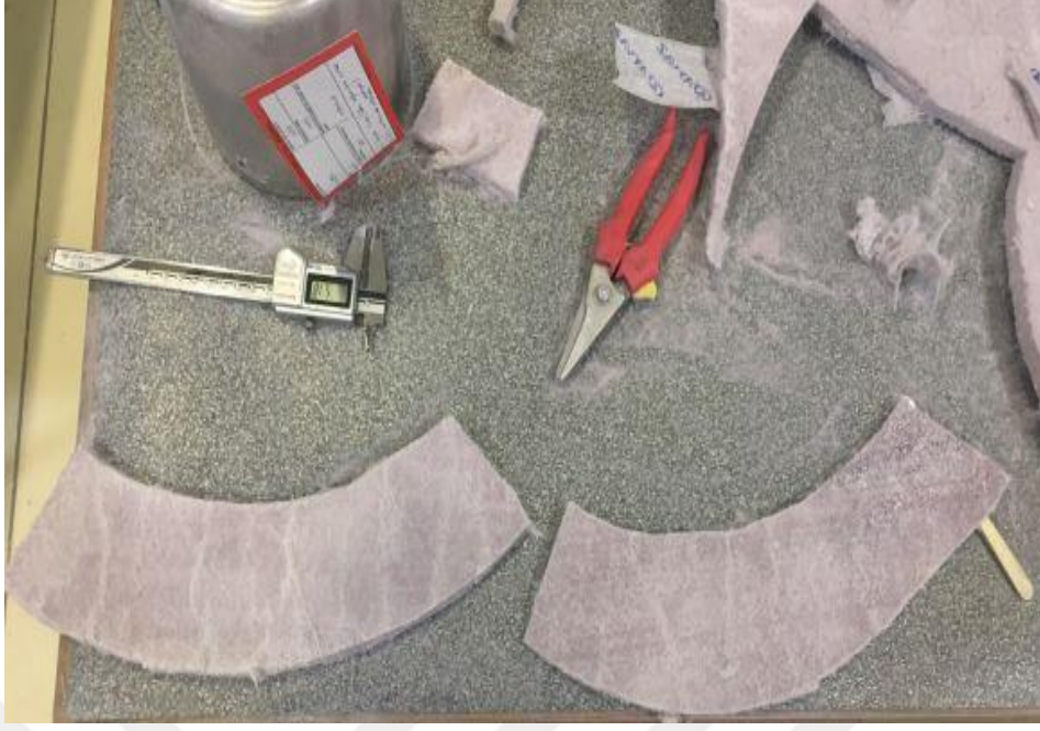
Şekil 8.3 10 mm ve 5 mm kalınlıklı battanilerin hazırlanması
