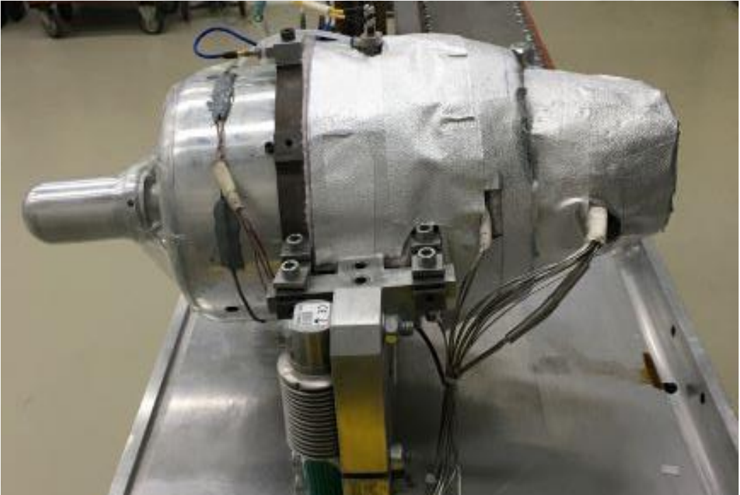
Şekil 8.16. Termal Yalıtımlı Motor sağdan görünüş
