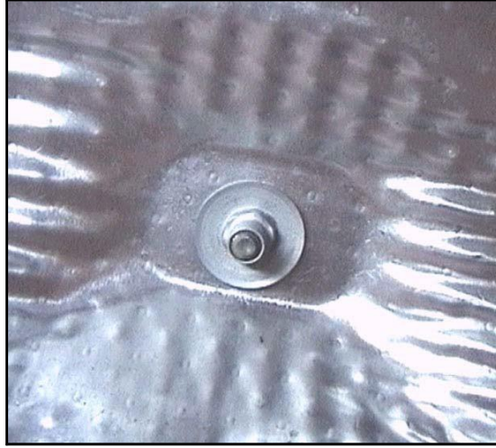
Şekil 4.18. Kaynaklı civata üzerine montajı yapılan ısı kalkanı uygulaması (Anonim,2019)
