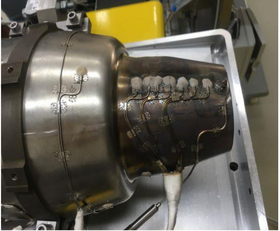
Şekil 8.14. Termal Yalıtımsız Motor Enstrümantasyonu
