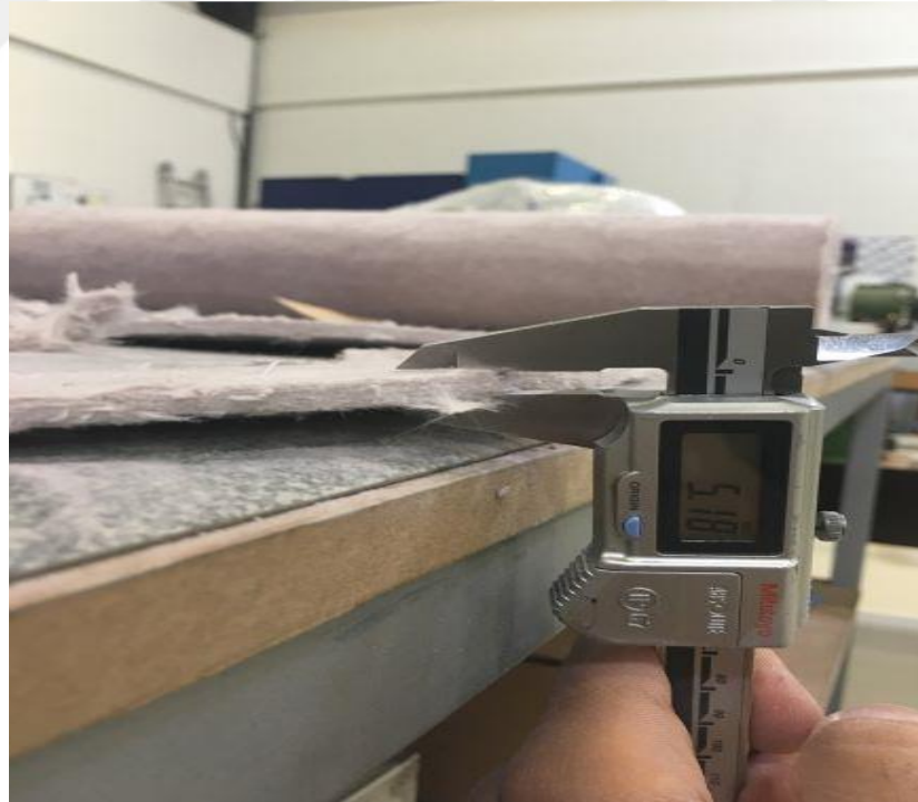
Şekil 8.6. 10 mm kalınlıktaki aerogel katmanının dijital kumpasla ölçümü
