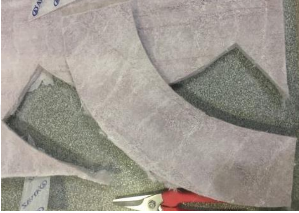
řekil 8.2 10 mm kalınlıktaki aerogel battaniyenin kesilmiř durumu
