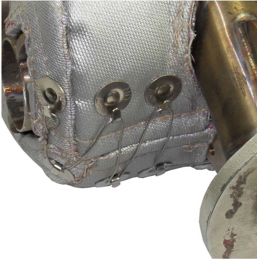
Şekil 4.19. Telle bağlama yöntemi ile yapılan montaj (Anonim,2019)
