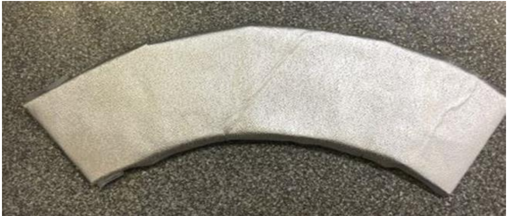
Şekil 8.11. Sandviç panelin tamamlanmış hali
