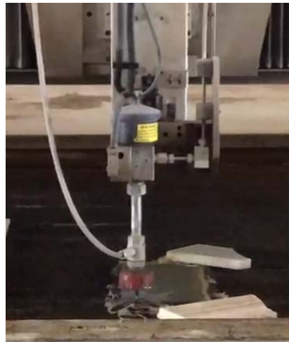
Şekil 3.4. Su jeti cnc makinası ile plakaların ASTM standartlarında kesilmesi
