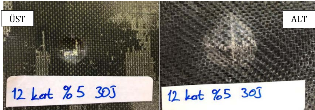
Şekil 4.5. TİC takviyeli numunelerin 30j uygulanmış hasarlı numune fotoğrafları
