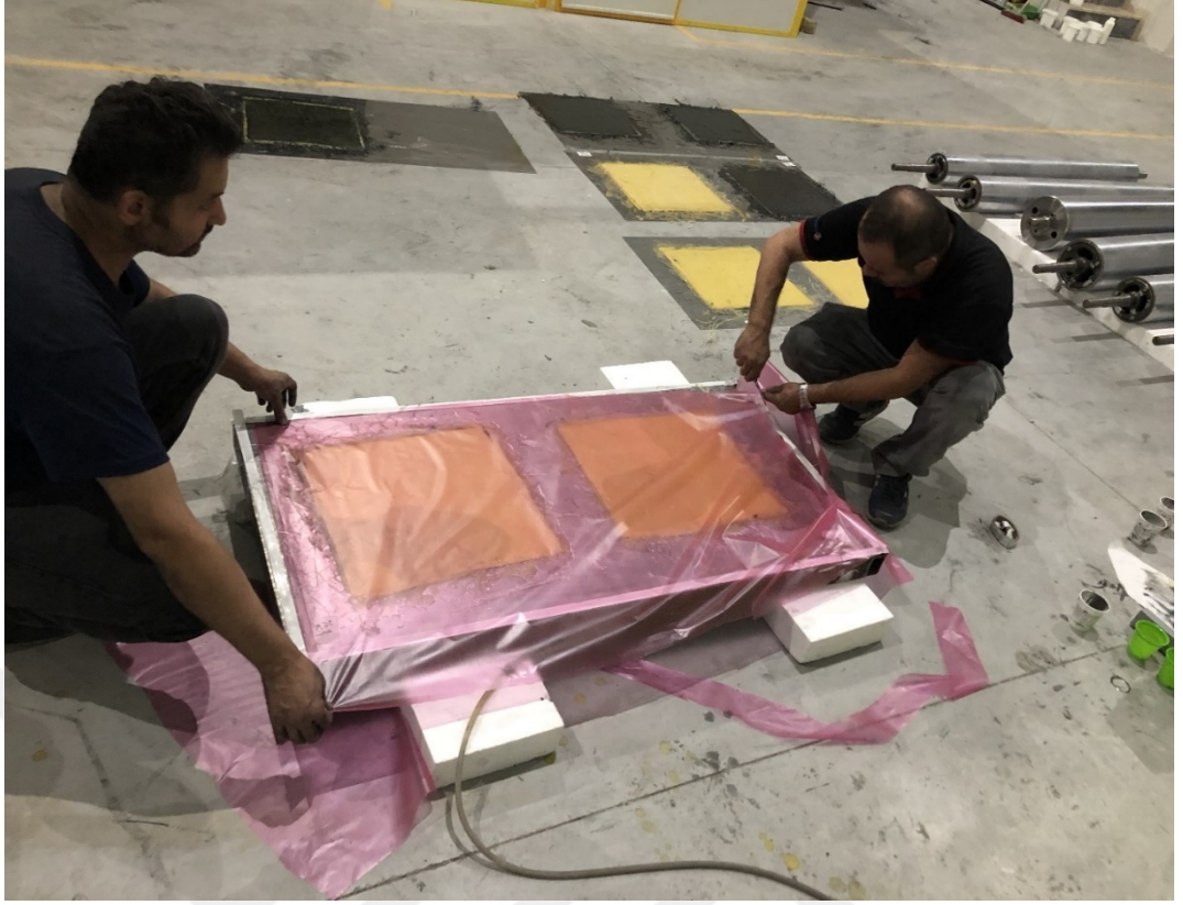
Şekil 3.3. Vakum uygulanan kompozit malzemeler
