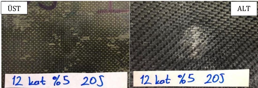
Şekil 4.3. TiC takviyeli numunelerin 20J uygulanmış hasarlı numune fotoğrafları
