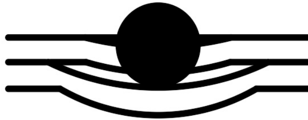
Şekil 1.6. Kompozit yapıda delaminasyon hasar görünümü
