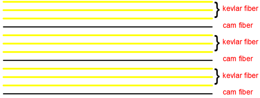
Şekil 1.2. Hibrit kompozit plakaların şematik katman dizilimi
