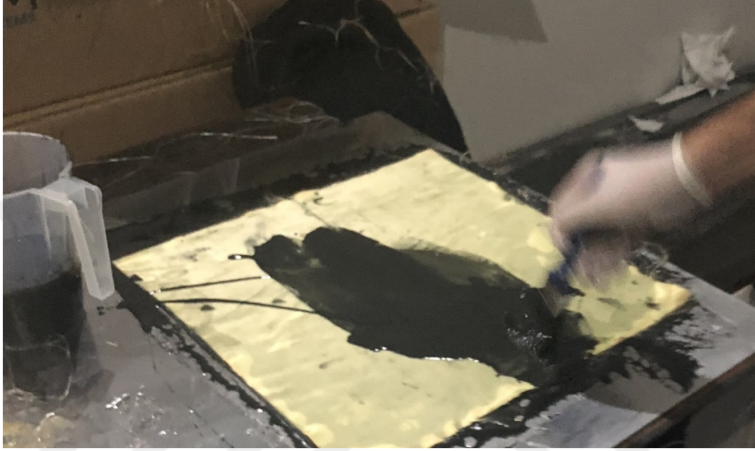
Şekil 3.1. El yatırma yöntemi ile numunelerin üretimi
