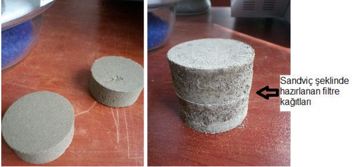
Şekil 5.17 Filtre kağıtlarının zemin numuneleri arasına yerleştirilmesi.
