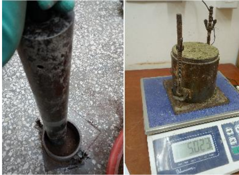
Şekil 5.7 Standart Proktor deneyi uygulaması.
