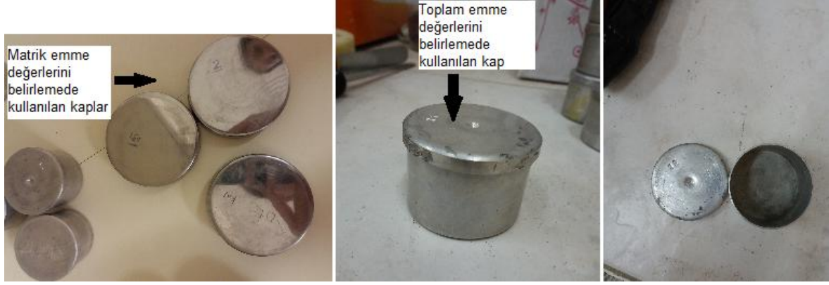
Şekil 5.22 Matrik ve toplam emmeyi belirleme de kullanılan alüminyum kaplar
