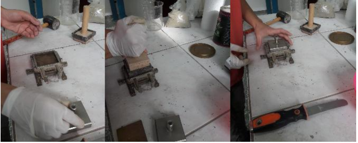
Şekil 5.9 Kesme kutusu deney aletinde makaslanması için hazırlanan zemin numunesi.
