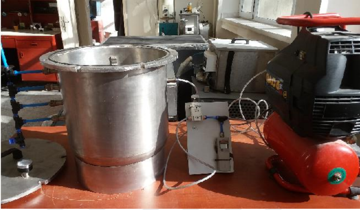
Şekil 5.28 Laboratuvarda kullanılan basınç plakası deney düzeneği ekipmanları.
