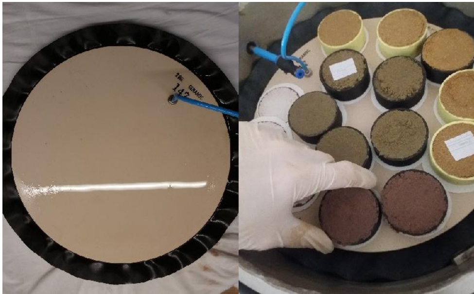
Şekil 5.30 Seramik disk üzerine numunelerin yerleştirilmesi.
