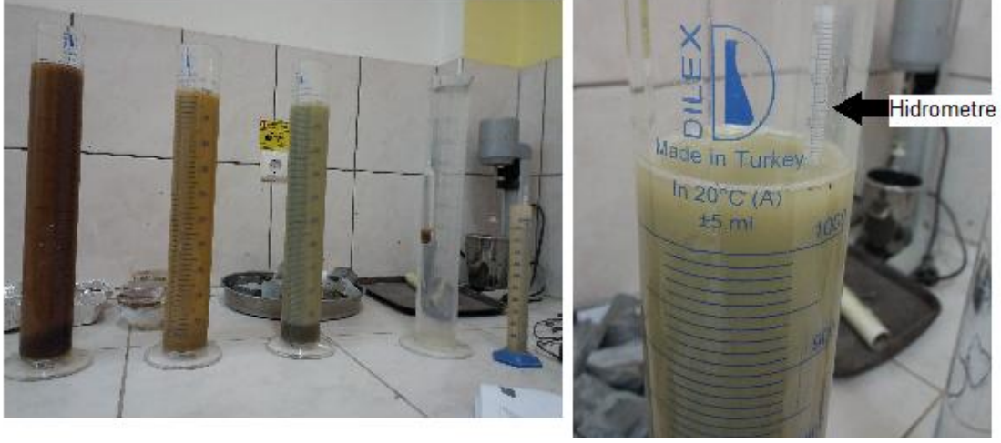
Şekil 5.2 Üç zemin türünde gerçekleştirilen hidrometre deneyi .
