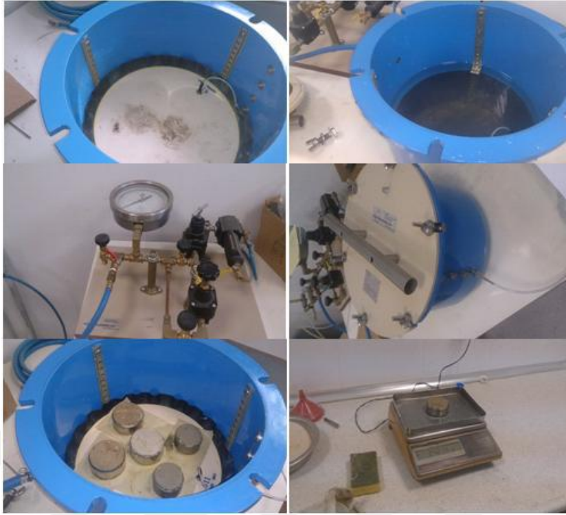
Şekil 2.6 Gökoğlu tarafından İstanbul Teknik Üniversitesi İnşaat Mühendisliği Laboratuvarında kullanılan basınç plakası deney aleti [9].
