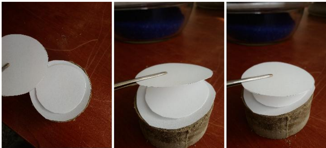
Şekil 5.16. Filtre kağıtlarının sandviç şeklinde hazırlanması.
