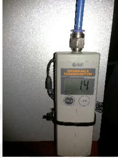
Şekil 5.33 Basınç plakası deneylerinde kullanılan manometrenin yakından görünümü.
