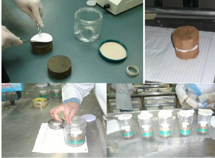
Şekil 2.8 Fattah vd. zemin numuneleri üzerinde gerçekleştirmiş oldukları filtre kağıdı deney aşamaları [12].
