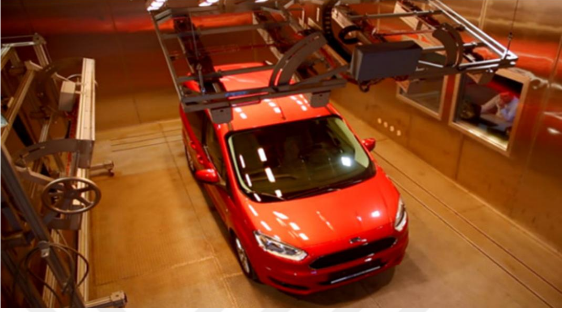
Şekil 3.17: Ford Otosan araç ve sistem test merkezi iklimatik oda
