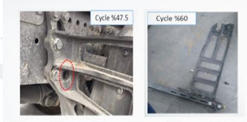
Şekil 4.34: Fiziksel yol testi sonucu meydana gelen yorulma kırığı
