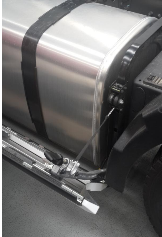
Şekil 3.6: Kamyon yan eteği halatlı kilit açılma mekanizması örneği
