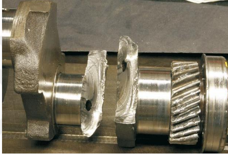
Şekil 1.1: Yorulma hasarına uğramış yapı elemanı
