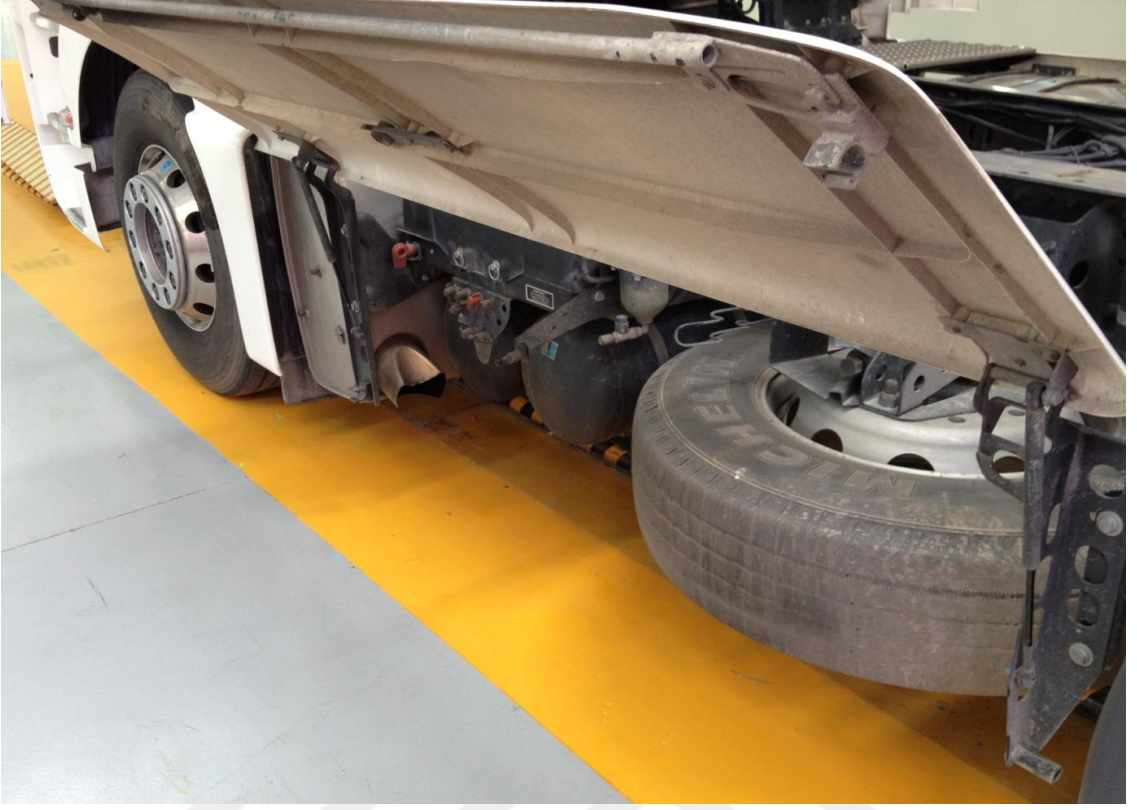
Şekil 3.5: Kamyon yan eteği pnömatik açılma mekanizması örneği
