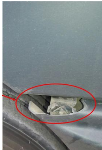
Şekil 3.7: Şasiye bağlı çamurluk kapama parçasının titreşim kaynaklı kırılması
