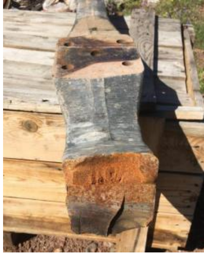
Şekil 2.2: Yorulma kaynaklı aks kırılması
