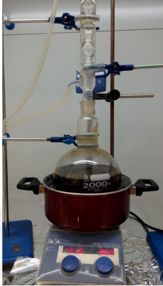
Şekil 2.7 : Vinil asetat modifikasyonu deney düzeneği
