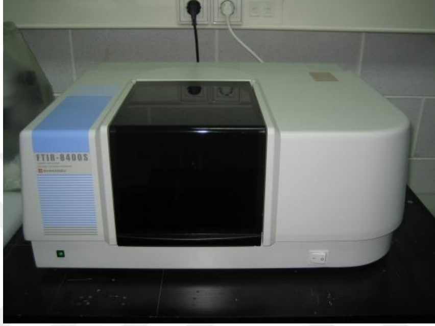
Şekil 2.8 : FTIR Shimadzu 8400s markalı spektrofotometre cihazı
