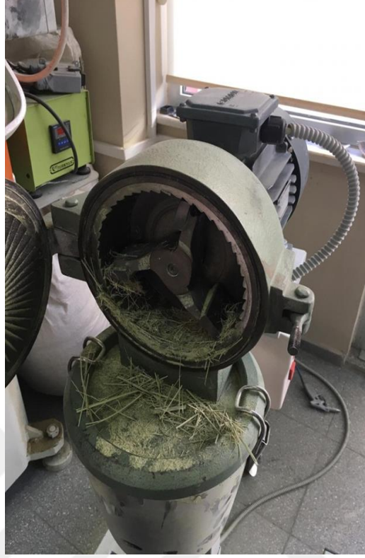
Şekil 2.2 : Mertest LB160 Laboratuvar Tipi Bıçaklı Öğütücü
