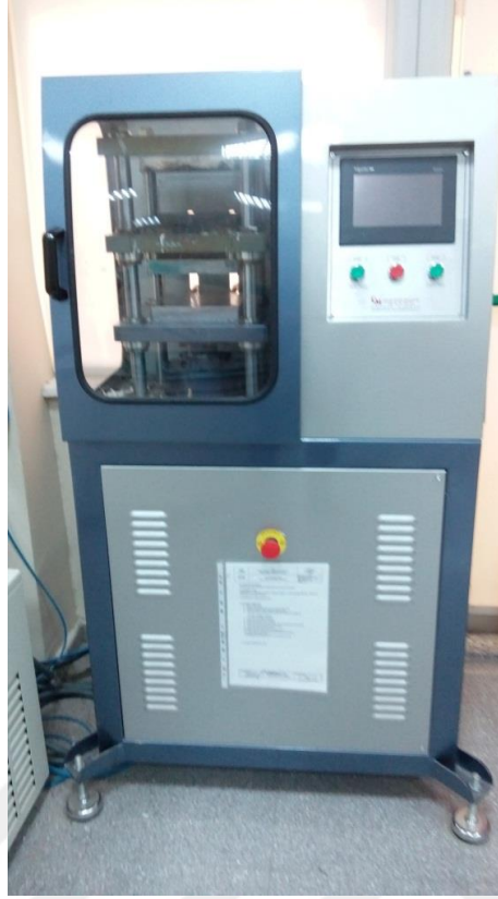
Şekil 2.9 : Gülnar ısıtma-soğutma üniteli laboratuvar tipi hidrolik pres
