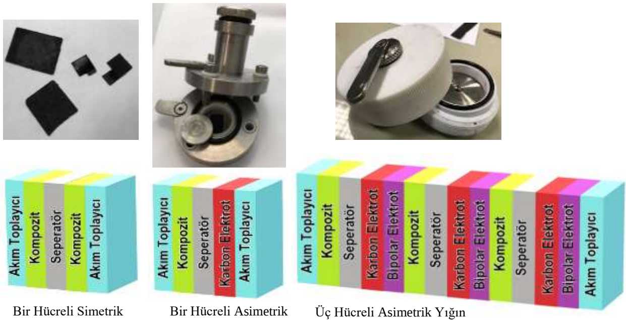
Şekil 3.2. İki elektrotlu sistemde kullanılan GK elektrot, bir hücreli simetrik ve asimetrik, üç hücreli asimetrik yığın için kullanılan split test hücreleri ve tasarımları.
