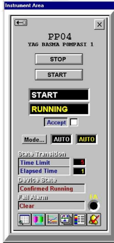
Şekil 5.9. Pompa Faceplate Resmi
