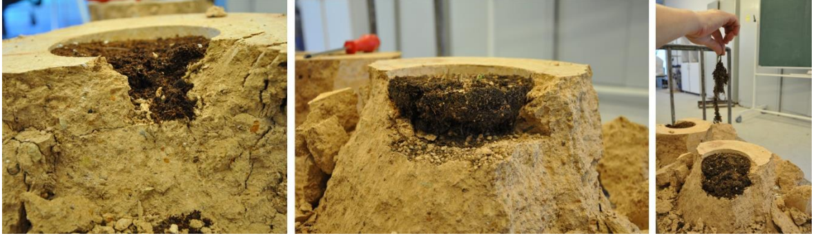
Şekil 5.17. Kontrol bloğunda nebati toprağın dağıldığı, mikoriza ekilen blokta toprağın şeklini koruyarak sıkılaştığı gözlemlenmiştir. Bitkinin mikoriza ile birlikte kök gelişimi
