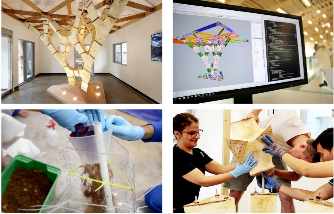
Şekil 3.6. MycoTree genel görünüm, yapı bileşenlerinin 3B modeli, miselyum blokların hazırlık aşaması, miselyum blokların bambu geçme sistemler kullanılarak birleştirilmesi (URL-12)
