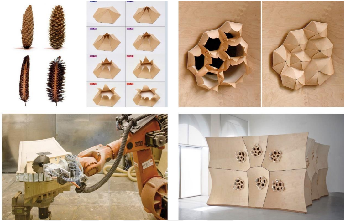
Şekil 2.2. Çam kozalaklarının neme duyarlılık göstererek açılan pulları, ahşap kompozit malzemenin açık ve kapalı hali, yapı elemanlarının robotla üretimi, HygroSkin: Meteorosensitive Pavilion (URL-1)
