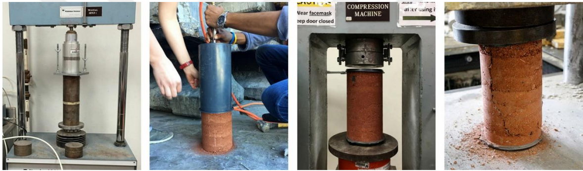
Şekil 4.1. Engineered Earth çalışması kapsamında yapılan basınç dayanım testleri (URL-13)
