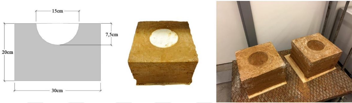
Şekil 5.8. Sıkıştırılmış toprak blok kesiti ve kalıptan çıkarılmış son halleri
