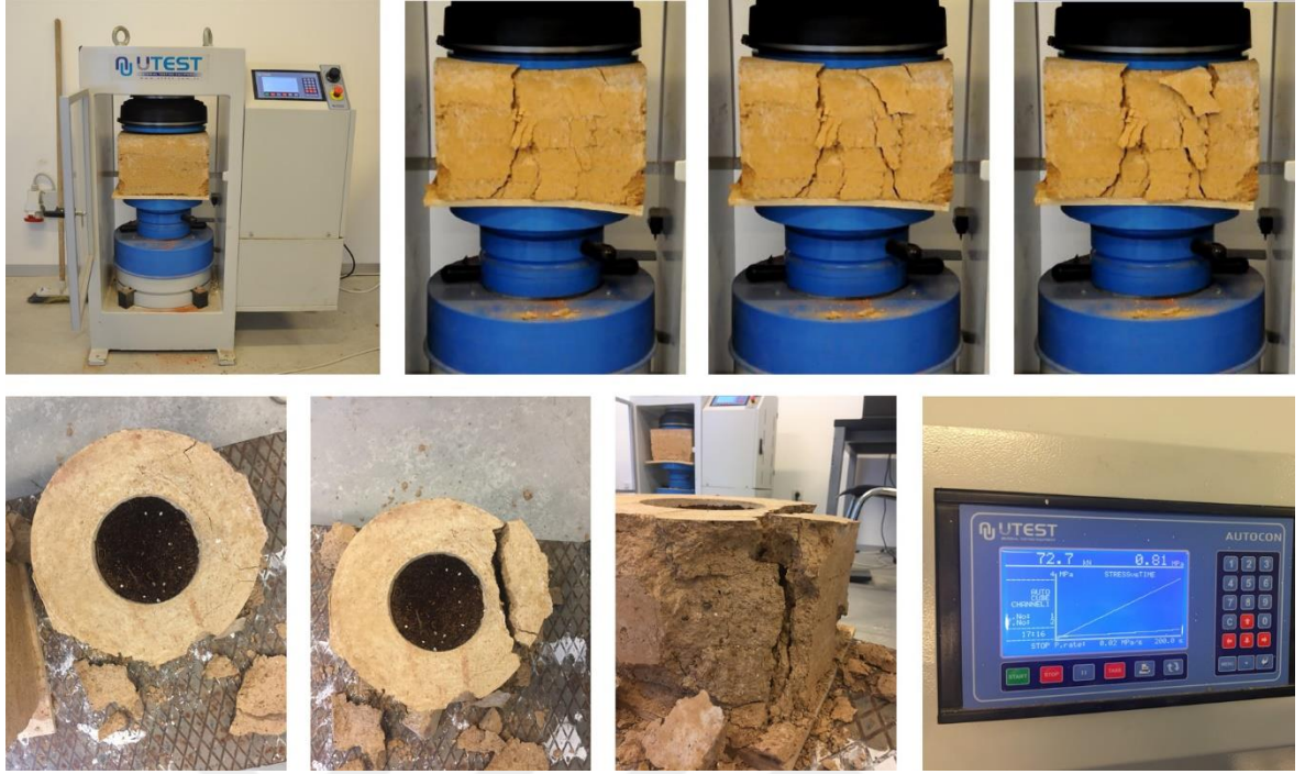
Şekil 5.15. Kontrol bloğu basınç testi süreci ve sonuç grafik
