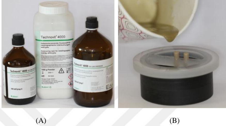
Şekil 3.4. A) Örneklerin hazırlanmasında kullanılan soğuk akrilik rezin, B) Hazırlanmış ve kalıba dökülen soğuk akrilik rezin.
