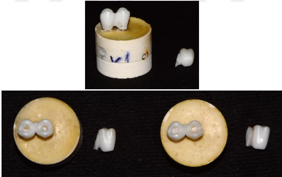
Şekil 4.1. Test edilen örneğin statik yükleme sonrası görüntüsü
