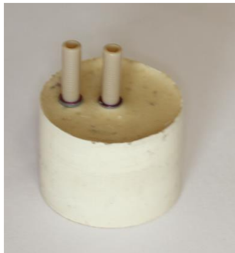
Şekil 3.5. Polimerizasyon sonrası üzerinde geçici dayanaklar bulunan örnek.
