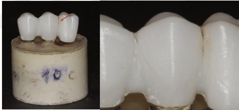
Şekil 4.3. Test edilen örneğin statik yükleme sonrası görüntüsü
