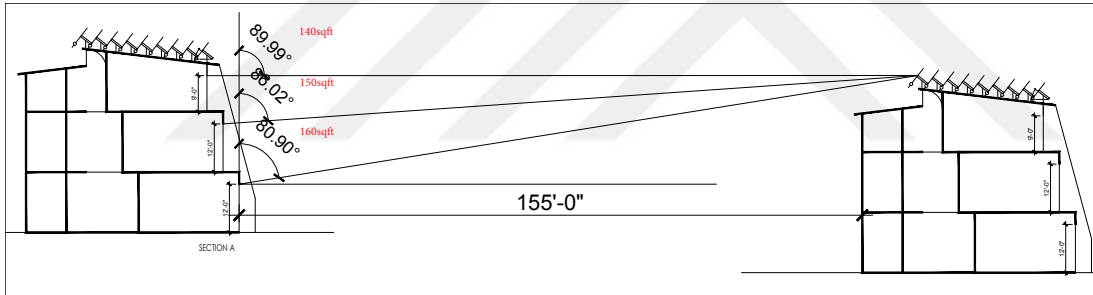
Şekil 5.65. Okul binalarının birbiriyle ilişkisi ve ışık bloke açıları (Vardar, Ekim, 2018).
