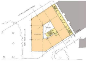
Şekil 4.4. Bullitt Center doğal aydınlatma ve havalandırma için kütle alternatifleri (Peña, 2014).
