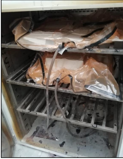
Resim 6.19. Kalıpların fırına alınması
