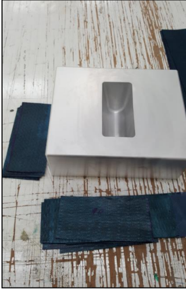
Resim 6.8. Darbe sönümleyici kalıbına serilecek kompozit malzemeler
