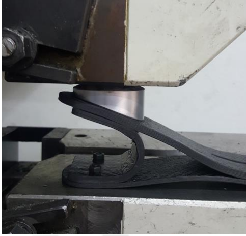
Resim 11.2. Kompozit ayak modeli basma testi
