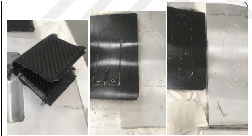
Resim 6.20. Kalıptan çıkarılan sırasıyla darbe sönümleyici, topuk ve omurga parçaları
