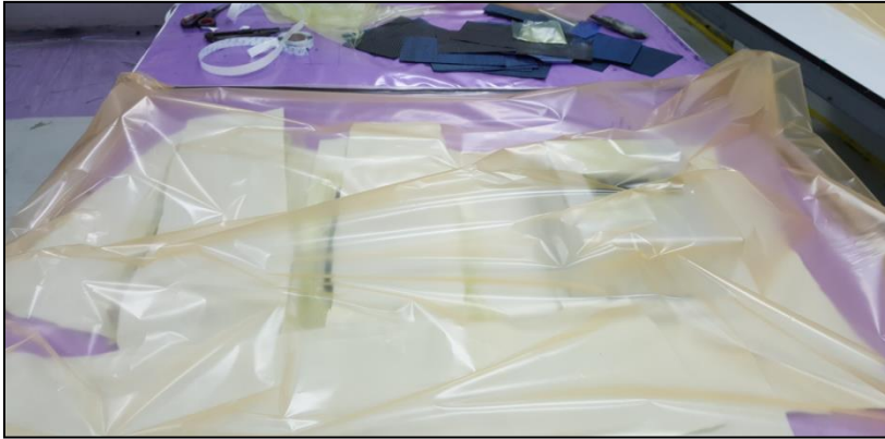
Resim 6.13. Vakum naylonunun serilmesi
