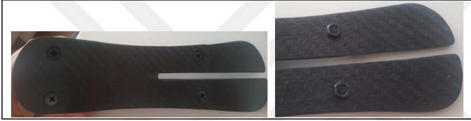
Resim 6.22. Trim işlemi bittikten sonra parçaların montajlanması
