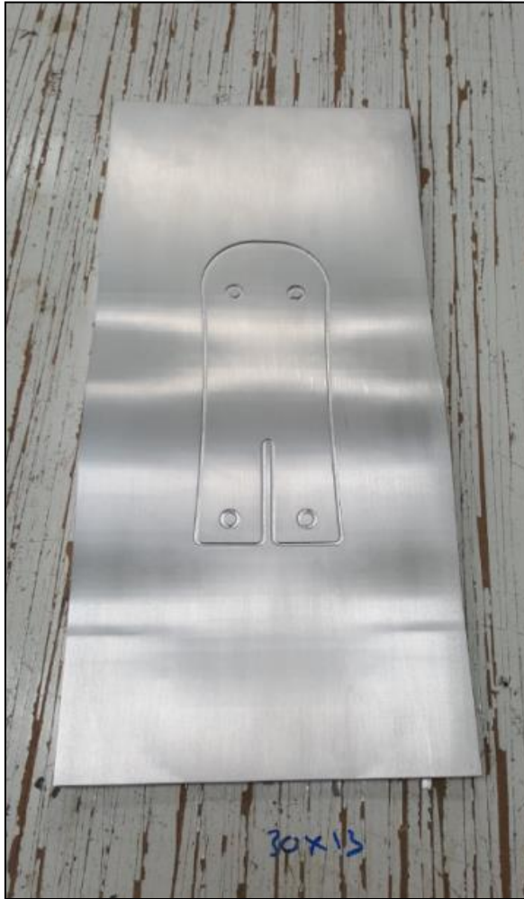
Resim 6.1. Topuk kalıbına serilecek malzeme ebatının belirlenmesi
