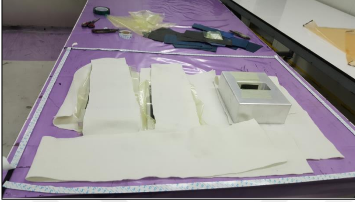
Resim 6.12. Sızdırmazlık bandının yapıştırılması
