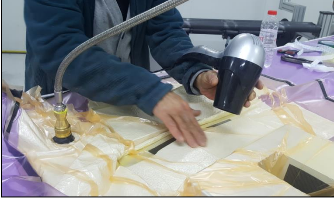
Resim 6.17. Vakumlanan kalıpların kurutma makinesi ile kurutulması
