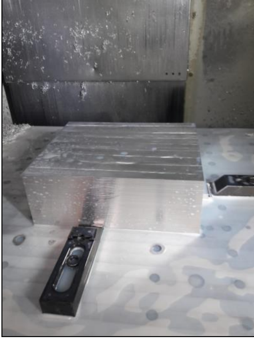
Resim 5.9. Darbe sönümleyici kalıbının CNC tezgahında işlenmesi
