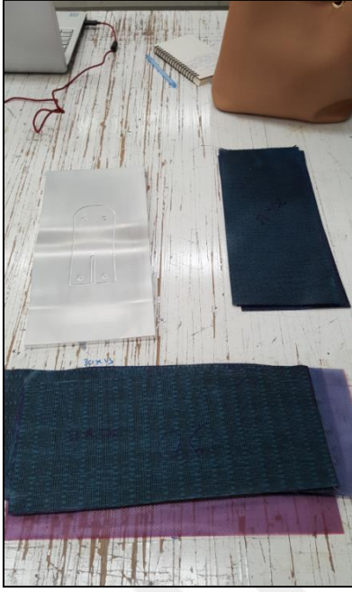
Resim 6.6. Topuk kalıbına serilecek kompozit malzemeler
