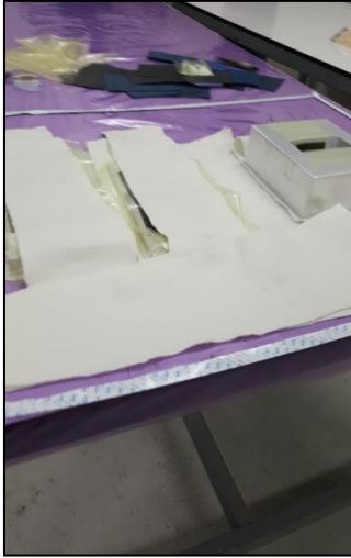
Resim 6.11. Release film üzerine battaniye atılması
