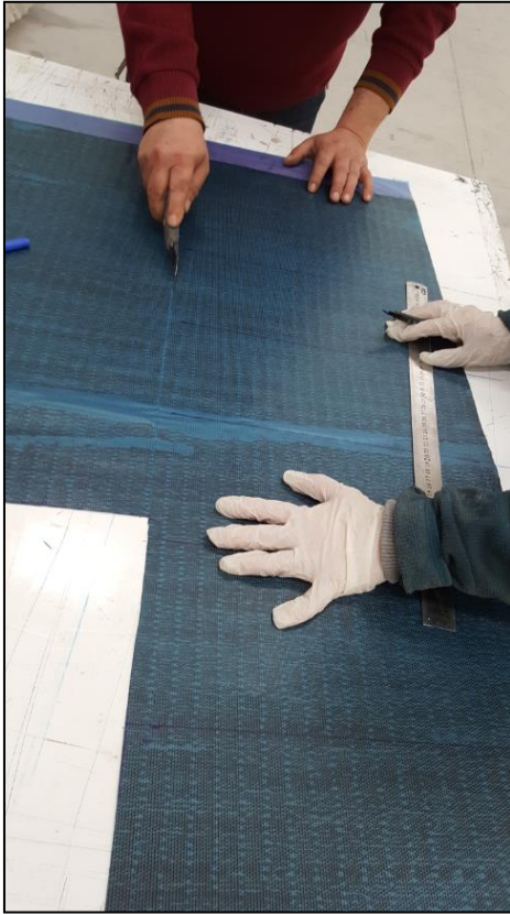
Resim 6.5. Tek yönlü olan epoxy carbon ud prepreg
