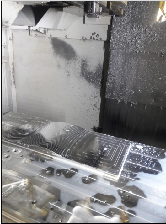
Resim 5.3. Topuk kalıbının CNC tezgahında işlenmesi
