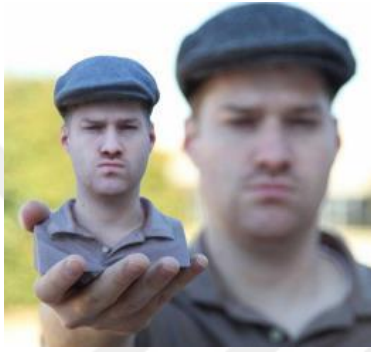
Şekil 1.37. Binder Jetting yazıcıdan alınmış insan büstü (URL-4, 2018).
