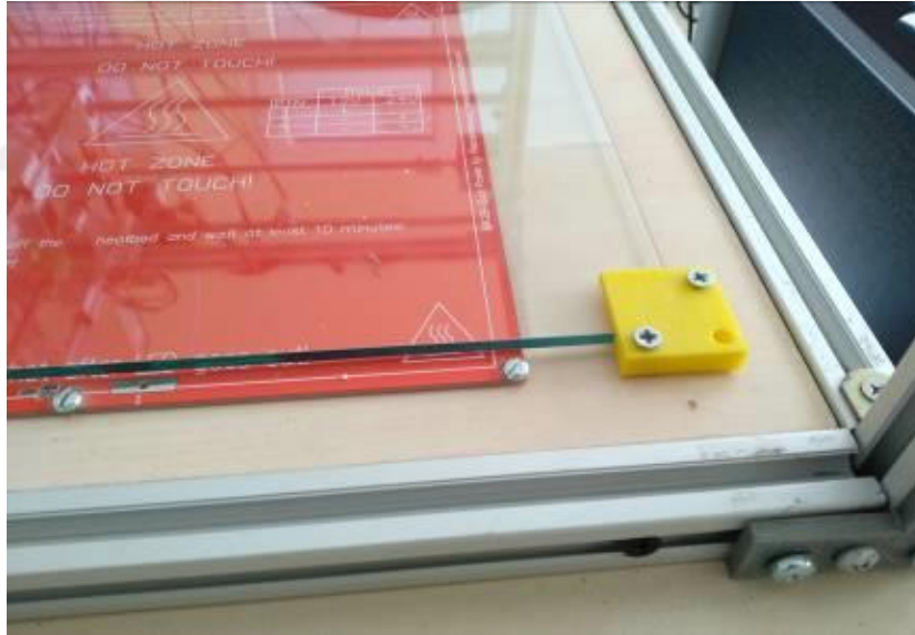
Şekil 3. 70. Isıtıcının tabla üzerindeki camının sabitlenmesi.
