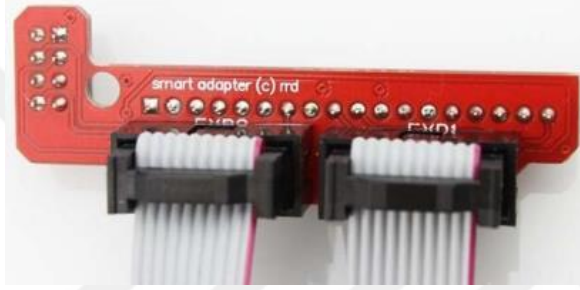
Şekil 3. 12. Akıllı ekran dönüştürücüsünün akıllı ekrana bağlanan pinleri.
