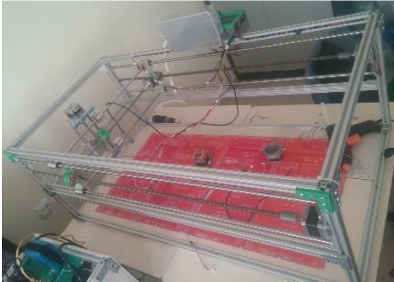
Şekil 3. 52. Üç boyutlu yazıcı şase montaj ii.
