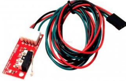
Şekil 3. 6. limit switch kablosuyla.
