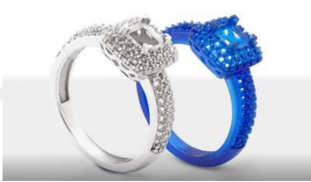
Şekil 1.17. SLA yöntemi ile üretim yapan yazıcıdan alınmış yüzük çizimi (URL-4, 2018).
