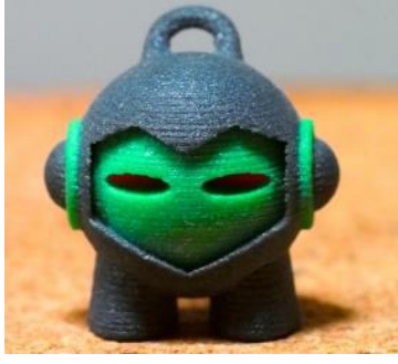
Şekil 1.36. Binder Jetting yazıcıdan alınmış baskı örneği (URL-4, 2018).
