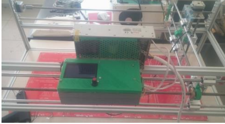
Şekil 3. 71. Üç boyutlu yazıcının kontrol ekranı, güç ünitesi ve yazıcının genel görünümü.
