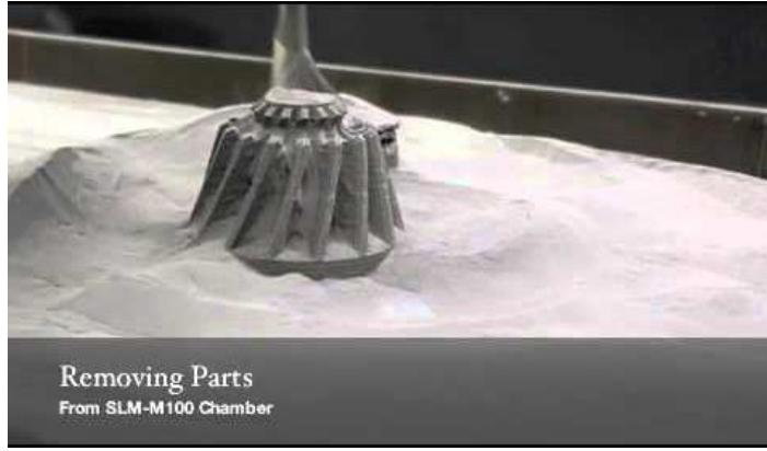
Şekil 1.32. SLM prensibi ile imalat yapan yazıcı ile basılmış jet motor parçası (URL-4, 2018).
