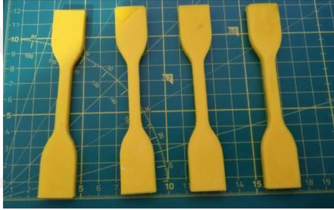
Şekil 4. 18. Çekme testinden önce numunelerin görünümü iii.
