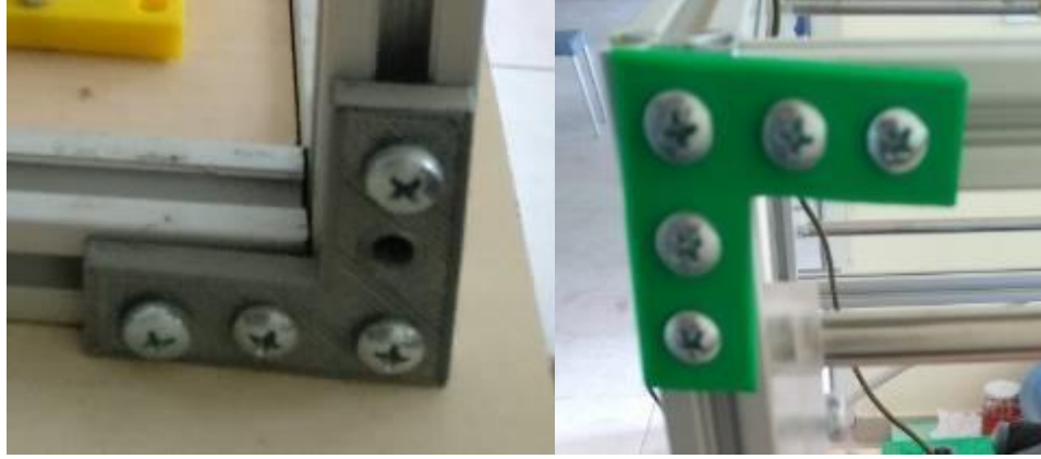
Şekil 3. 55. Üç boyutlu yazıcıda plastik baskı alınmış köşe bağlantıları ii.
