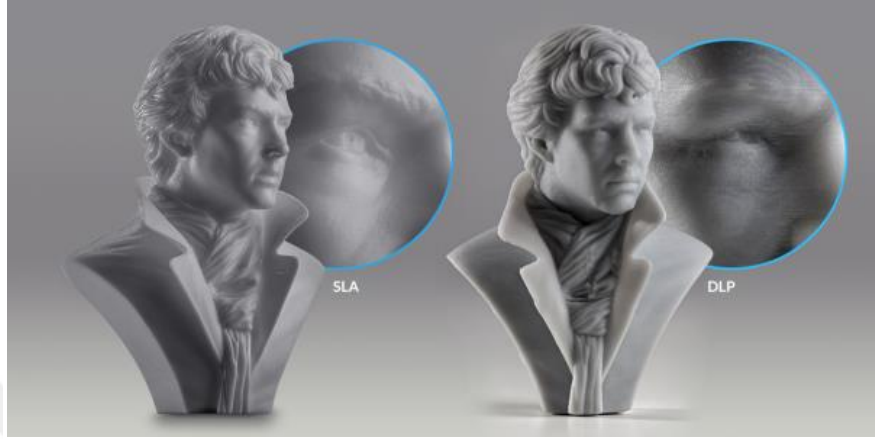
Şekil 1.19. SLA ve DLP prensibi ile çalışan yazıcıdan basılmış insan büstü (URL-4, 2018).
