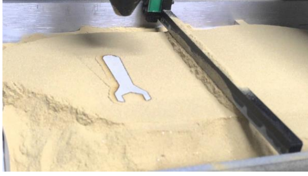
Şekil 1.23. SLS prensibi ile imalat yapan yazıcının baskı anı.
