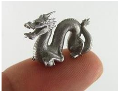
Şekil 1.31. SLM prensibi ile imalat yapan yazıcı ile basılmış ejderha tasarımı.
