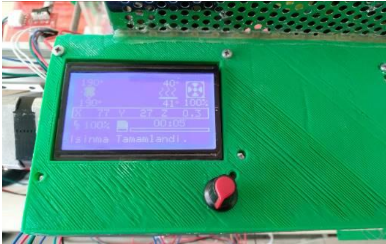
Şekil 3. 73. Üç boyutlu yazıcının kontrol ekranı.
