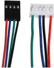
Şekil 3. 19. Nema 17 motor ramps bağlantı kablosu.
