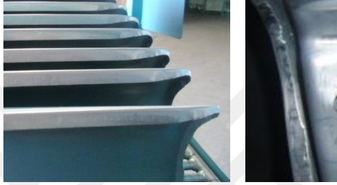
Şekil 3.31: Dış panel detayı ve kenar deformasyonu
