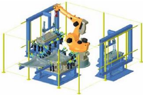
Şekil 3.28: Robotik silindir hemming ve yörüngesi
