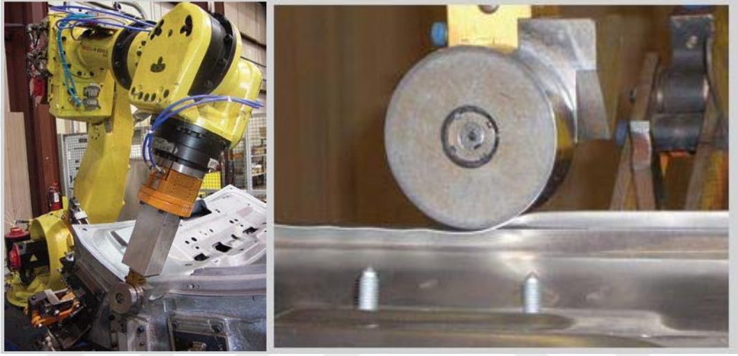
Şekil 3.15: Robotik silindir hemming görünüşü
