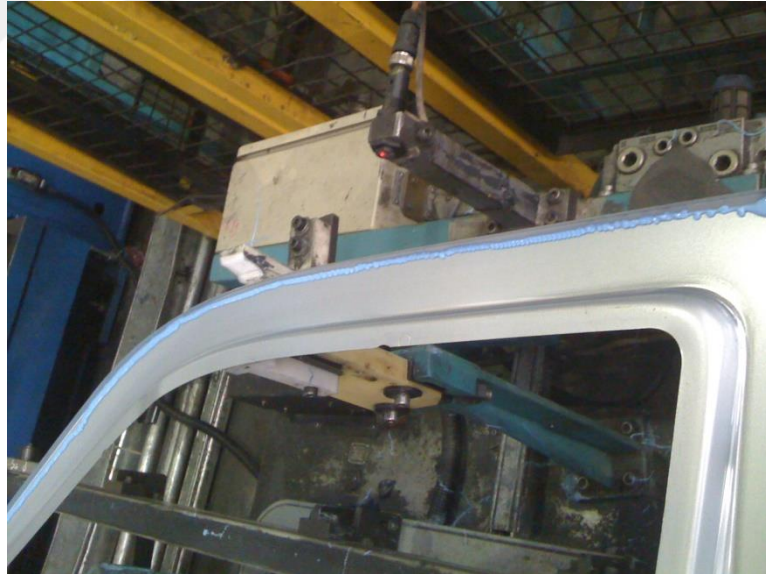
Şekil 2.19: Dış panel mastik işlemi
