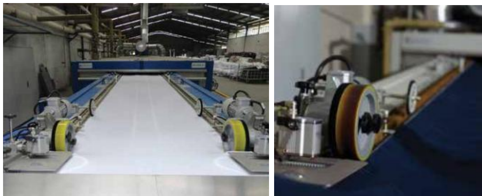
Şekil 1.13 Germe Giriş Palet Sistemi ve Avans Besleme Silindirleri
