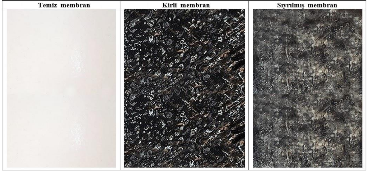
Şekil 4.24: Temiz, kirli, sıyrılmış membranların fotoğrafları.
