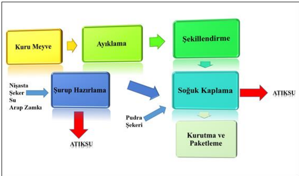
Şekil 2.3: Yumuşak şekerleme üretiminde atıksuyun oluşma süreci.
