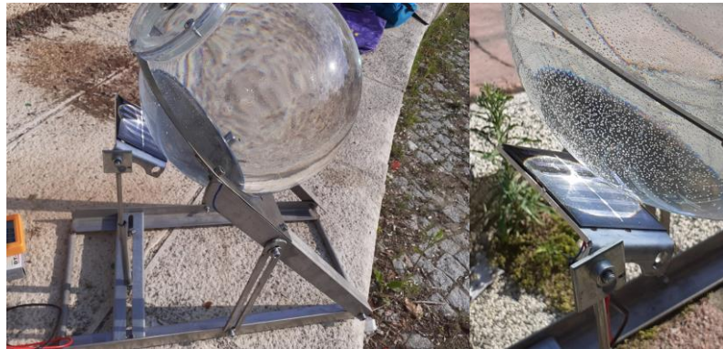
Şekil 3.6. Küre ve fotovoltaik panel sehpa
