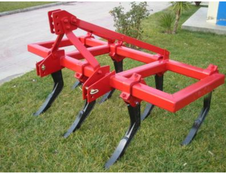
Şekil 3.6. Anız üzerine doğrudan çizi açmada kullanılan çizel aleti
