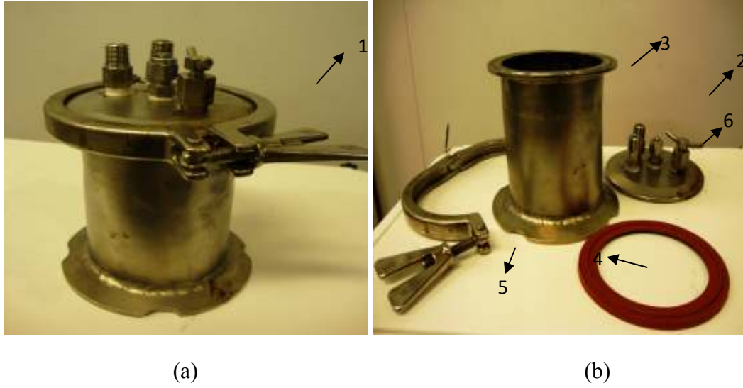
Şekil 3.2. (a) Monte edilmiş basınçlı reaktör, (b) Sökülmüş basınçlı reaktör (1.Basınçlı reaktör , 2. Basınçlı reaktör kapağı, 3. Basınçlı reaktörün gövdesi, 4. Conta, 5. Kapağı tutan kelepçe, kapak ve basınçlı reaktör gövde ile birlikte, 6. Basınç valfleri.)
