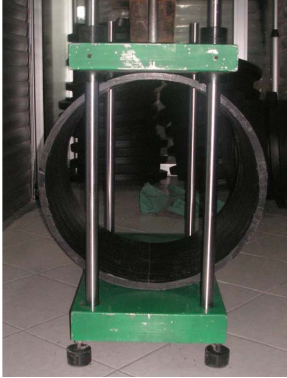
Şekil III.23 Test Cihazına Bağlanmış Profilsiz Boru Yan Görünüşü
