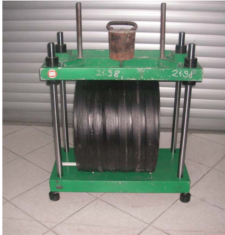
Şekil III.22 Test Cihazına Bağlanmış Profilsiz Boru Ön Görünüşü
