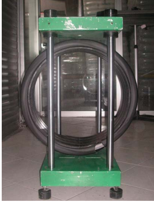
Şekil III.21 Test Cihazına Bağlanmış Profilli Borunun Yan Görünüşü
