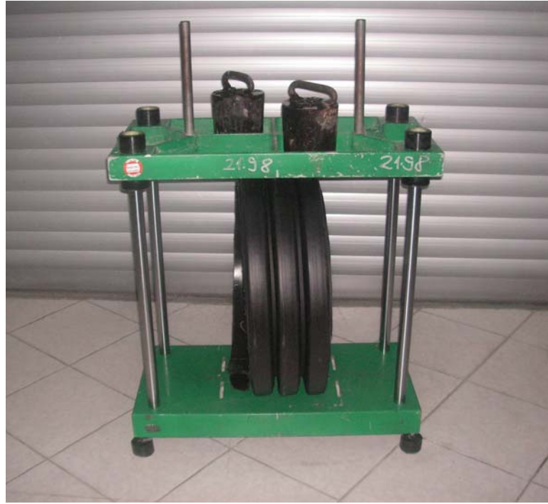
Şekil III.20 Test Cihazına Bağlanmış Profilli Borunun Ön Görünüşü
