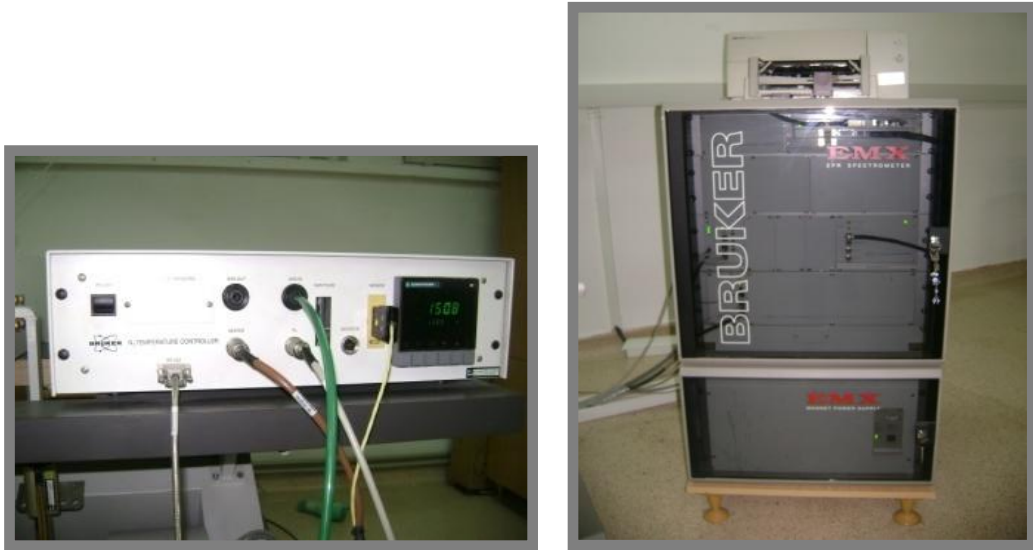
Fotoğraf 4.5 Kristal dedektör ve kaydedici spektrometre [52]
