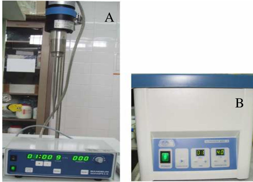
Şekil 3.1. Sonikasyon uygulanan cihazlar A) Prob tipi sonikatör; B) Banyo tipi sonikatör
