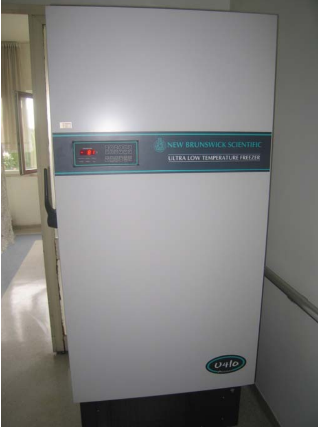
Şekil 3.1. Eksi 80 derece derin dondurucu (NEW BRUNSWICK SCIENTIFIC, MODEL: U410-86)
