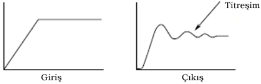
Şekil II.32 Sönümlü sistem cevabı
