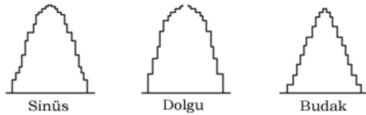
Şekil II.22 Microstep akım profilleri
