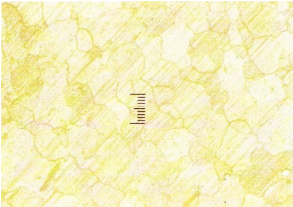
Şekil 6. 7 500x yakınlıktaki tane yapısı görüntüsü
