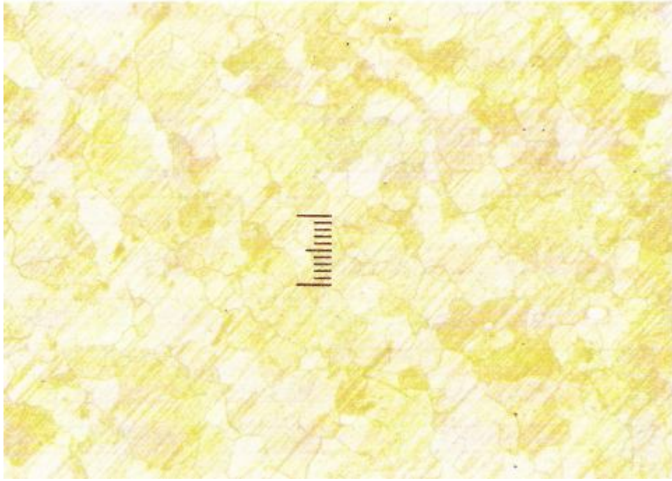
Şekil 6. 6 200x yakınlıktaki tane yapısı görüntüsü
