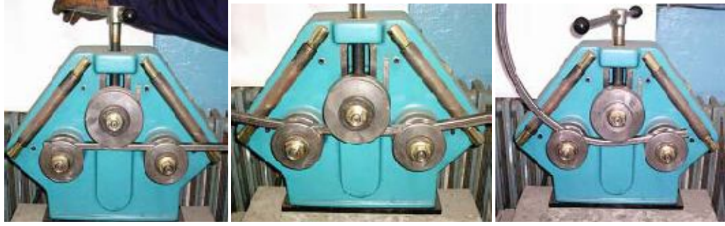
Şekil 1. 22 Parçanın merdaneye bağlanması, bükmeye başlanması ve parçanın bükülmüş şekli
