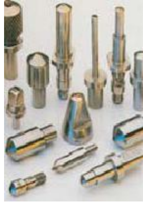
Şekil 5. 6 Vickers sertliğinde kullanılan batıcı uç çeşidi
