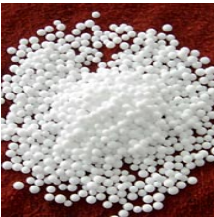
Şekil 2.19 EPS içeriğindeki köpük taneleri ve EPS levha örnekleri.
