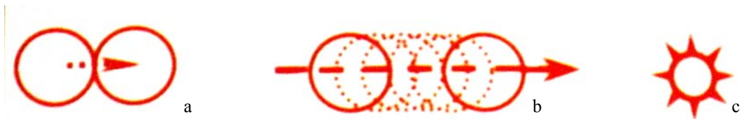
Şekil 1.1 a) İletim: Partiküllerin teması ile ısı transferi. b) Taşınım: Akışkan çevre ile ısı transferi. c) Radyasyon: Elektromanyetik dalgaların yayılımı ile ısı transferi (Mukhopadhyaya, P., çev., 2006).
