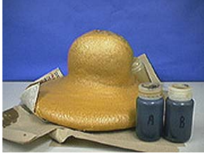
Şekil 2.16 I (A) ve II (B) bileşenleriyle üretilen PU Köpük.
