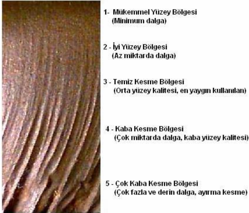
Şekil II.28 ASPK İle Kesilmiş Yüzey Kalitesi (Akkurt, 2009)
