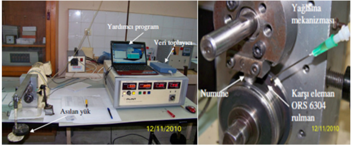
Şekil 5.15. Aşınma Test Düzenegi
