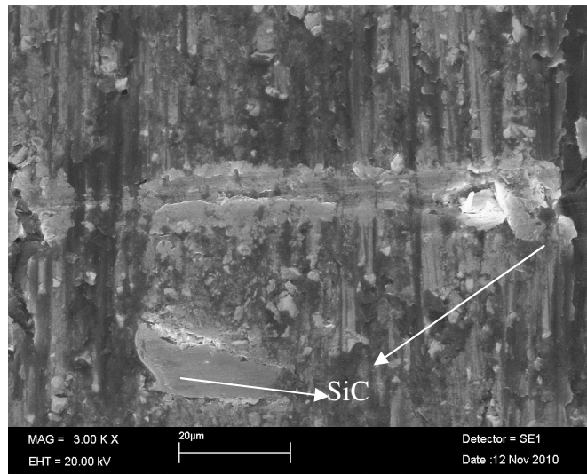
Şekil 5.23. AA6061/SiC20 \mu /5/Co kompozitinin yağlı şartlarda 50 N yük ile aşınma sonrası yüzeyi
