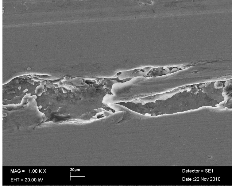
Şekil 5.52. AA6061/C0 numunesi yağlı şartlarda 50 N yük ile aşınma sonrası yüzeyi
