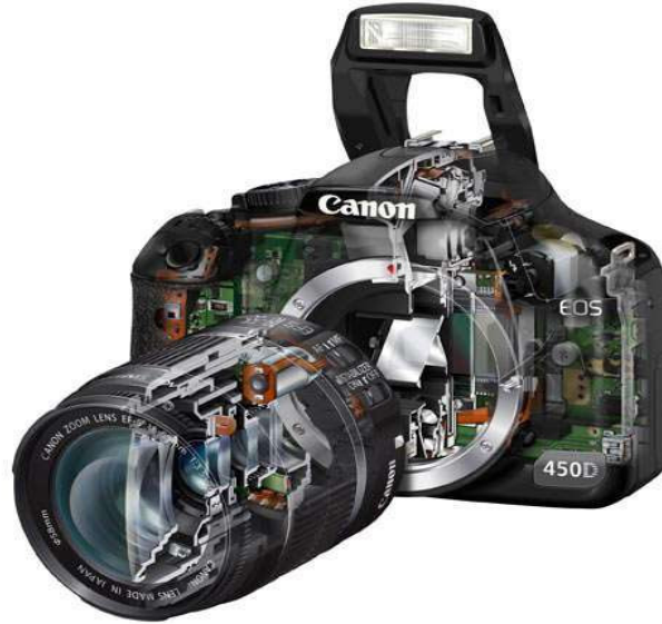
Resim 2.9: Dijital Fotoğraf Makinesi Kesiti
