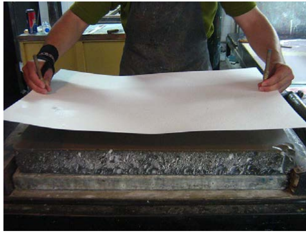
Resim.2.3.9 Baskı kağıdının taş üstüne yerleştirilmesi
