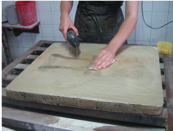
Resim.2.3.4 Desenin terebentin ile sökülmesi
