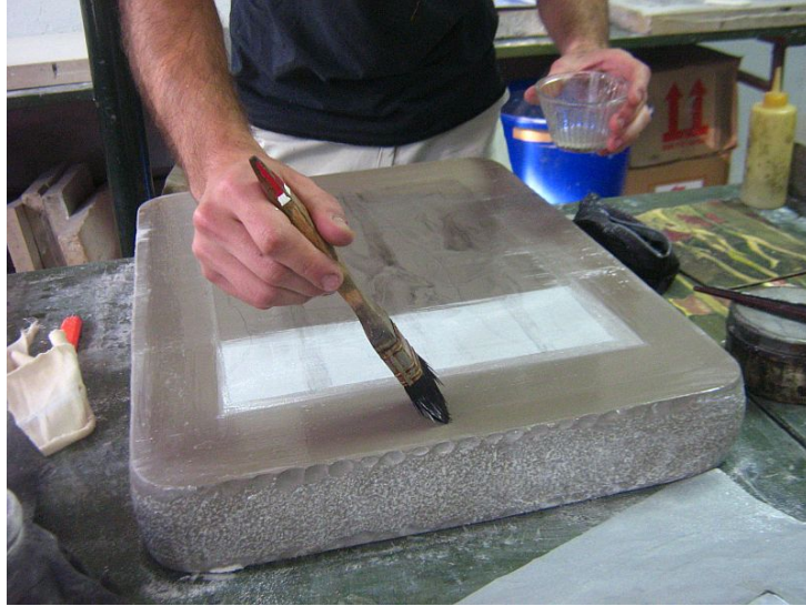
Resim.2.3.3 Desene arap tutkalı ve nitrik asit karışımının tatbik edilmesi
