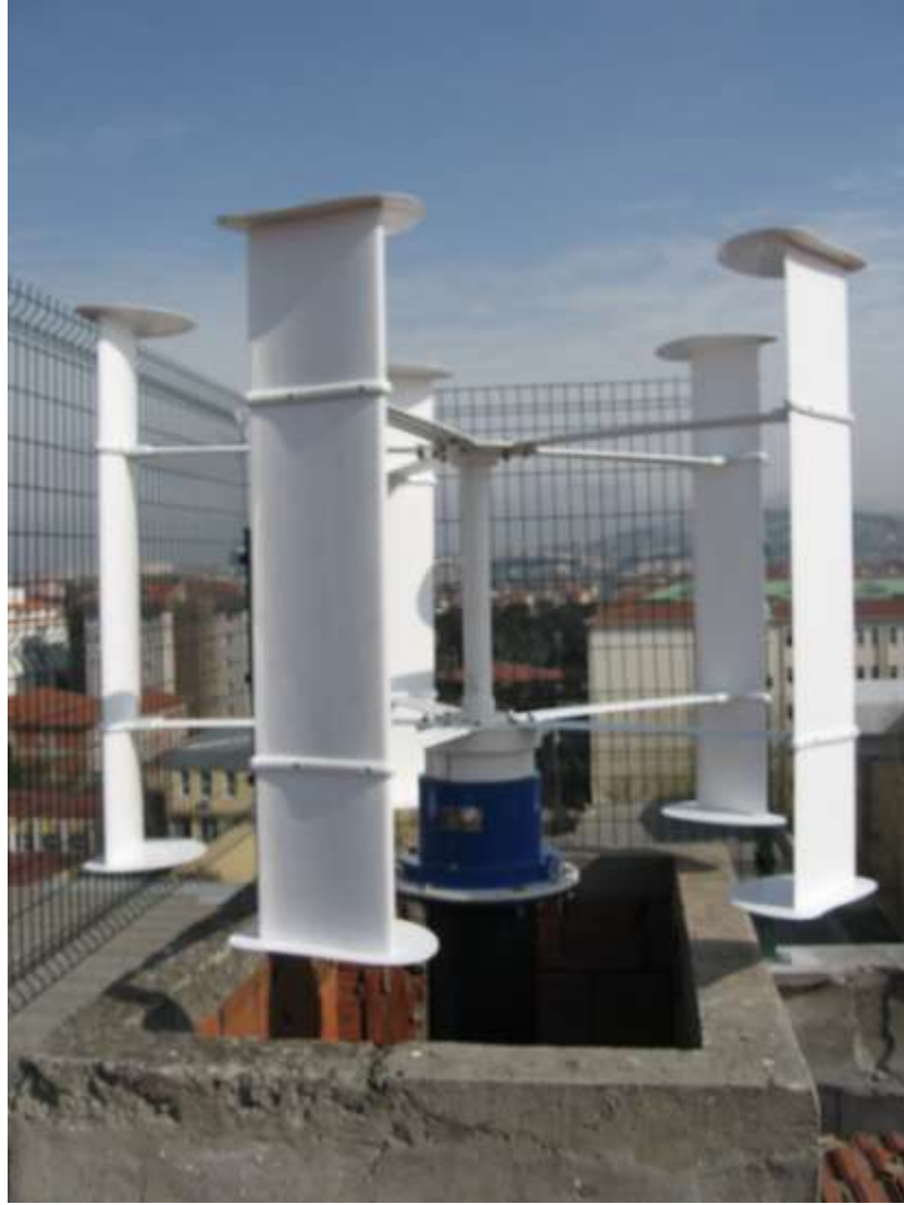
Şekil IV.6 Montajı Yapılmış Düşey Çalışan Rüzgâr Türbini.
