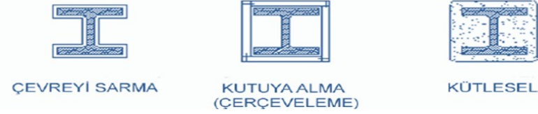
Şekil 4.5 Çelik yapı bileşenlerine uygulanan yalıtım türleri[22]
