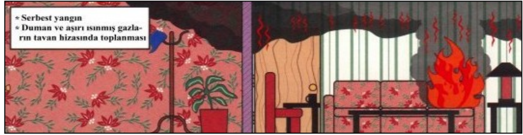
Şekil 2.2b Yarım yanmış gazların tavan hizasında toplanması[2]
