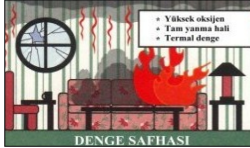
Şekil 2.3a Yanma periyodunun denge hali[2]
