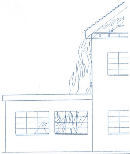
Şekil 4.4 Alevlerin saçaktan çatıya sıçraması[21]
