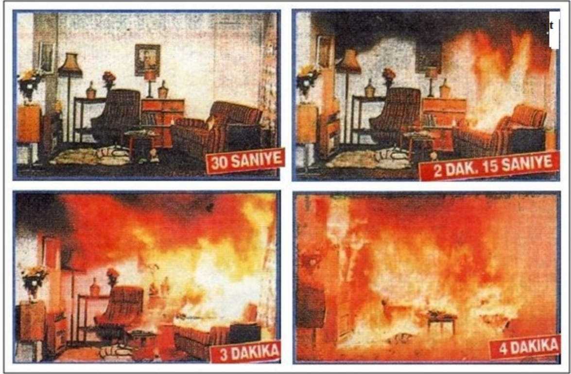
Şekil 2.8 Yangının Büyüme Hızı Deneyi: Sıvılarda bu hız çok daha fazla, gazlarda ise anlaktır[2].
