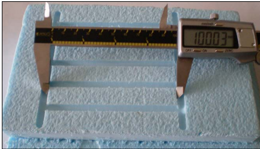
Şekil 5.5. Y Ekseninde Kanallardan Ölçü Alınması.
