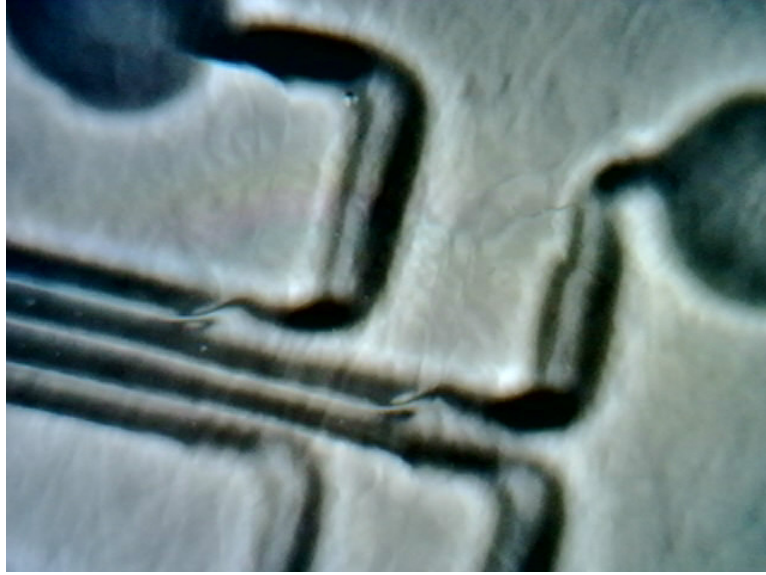
Şekil 4.27. 200 \mu\text{m} genişlik ve 200 \mu\text{m} kanal aralığına sahip mikrokanalların mikroskop görüntüsü
