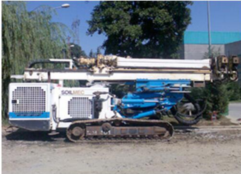
Şekil 3.1. Soilmec SM – 401 Ön Delgi Makinası.
