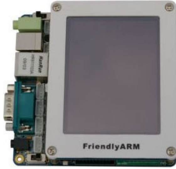
Şekil 6. 3. Mini2440 + 3.5" Renkli LCD & Dokunmatik Ekran
