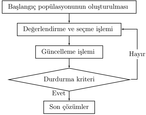
Şekil 2.10. Parçacık sürü optimizasyon algoritmasının temel akış diyagramı.
