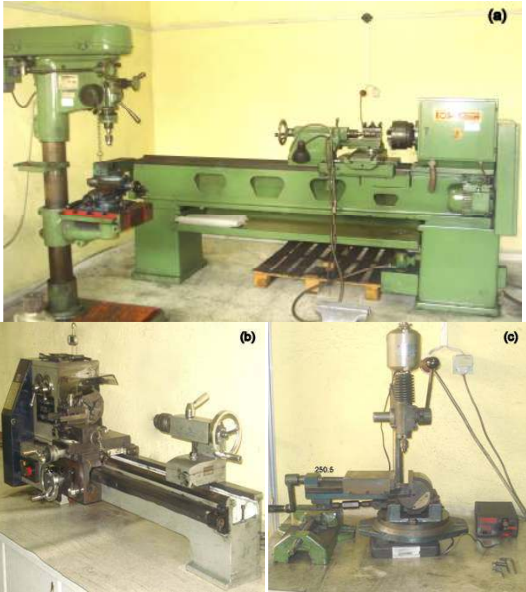
Şekil 3.12. Grafitlerin işlenmesinde kullanılan (a) Büyük torna ve doğrusal matkap, (b) Küçük torna ve (c) Yönlü matkap.
