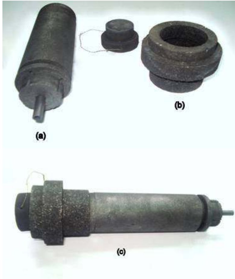
Şekil 3.5 (a) Alaşımın taşmadan kolaylıkla akmasını sağlayan 65 mm derinlikli grafit pota (b) Grafit potanın üstüne yerleştirilen 4 tane havalandırma deliğine sahip üst dengeleyici (c) Üst dengeleyici, grafit pota ve koruma kapağından oluşan, eriyik alaşımın rahatça kalıba dolması için kullanılan akıtma hunisi.
