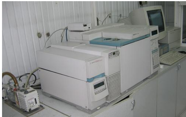
Şekil 4.1: Çalışmada kullanılan HP 6890 GC/ HP 5973N MS sistemi
