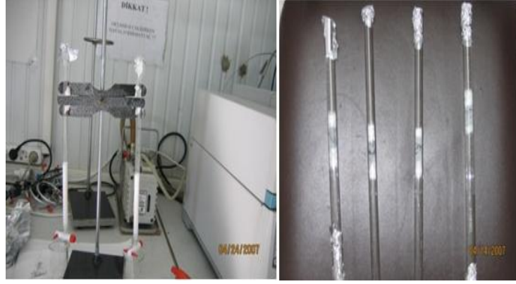
Şekil 4.13: Silikajel, alümina ve karbon temizleme prosedürü
