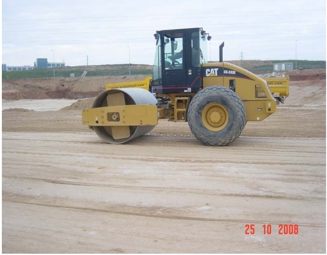
Şekil 2.8: Düz ayaklı silindir
