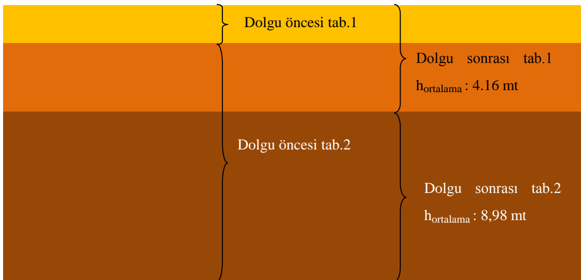
Şekil 5.9: Dolgu çalışması öncesinde ve sonrasında uygulama yapılan araziye ait zemin profili
