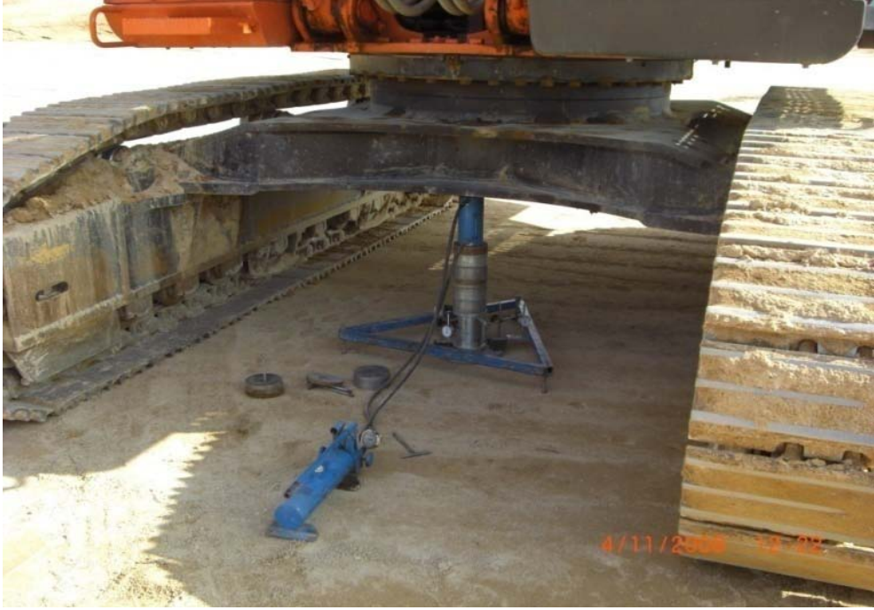
Şekil 4.20: Granüler dolgu üzerinde yapılan plaka yükleme deneyi
