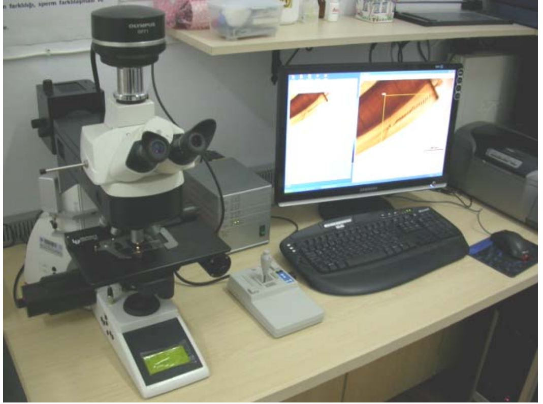
Şekil 3.5 Bilgisayara bağlı mikroskop-kamera sistemi.
