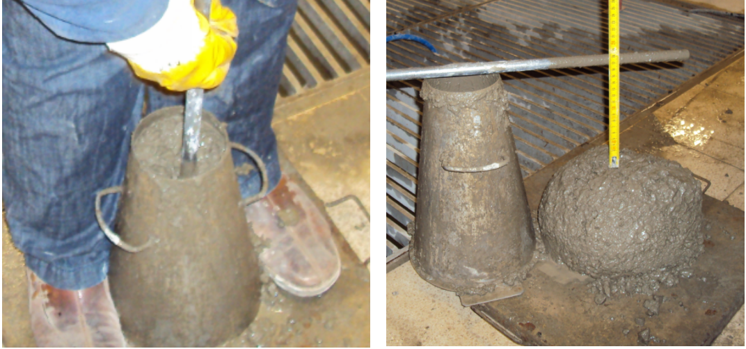
Şekil 5.2: Çökme deneyinin yapılışı
