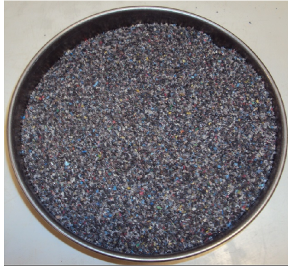
Şekil 4.1: Granül haldeki kablo atığından elde edilmiş kauçuk
