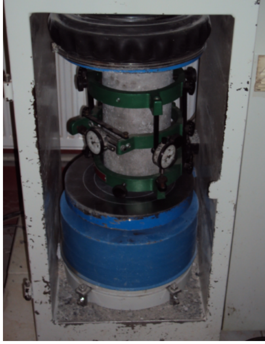
Şekil 5.12: Elastisite modülü tayini deneyi
