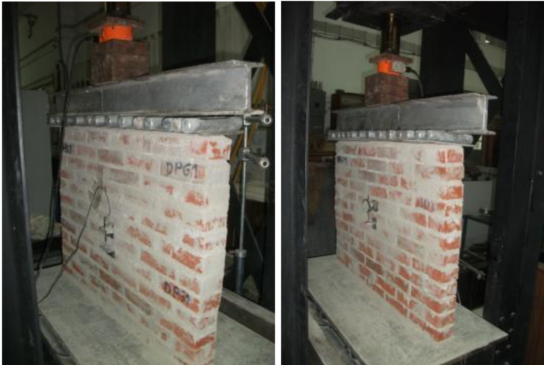
Şekil 4.94. Güçlü harçlı 100 x 75 cm'lik Dolu Pres Tuğla Panel Numunesi (DPG1)
