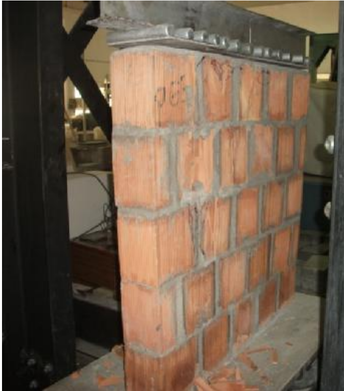
Sekil 4.59. Güçlü Harçlı 1x1m'lik Yatay Delikli Panel Numunesi (PG3)
