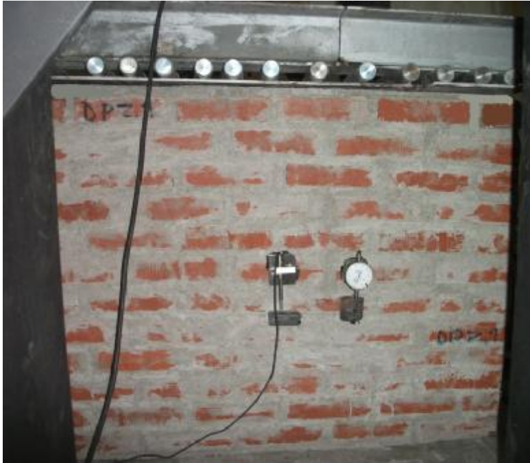
Sekil 4.71. Zayıf Harçlı 100x75 cm’lik Delikli Pres Tuğla Numunesi (DPZ1) Yükleme Öncesi
