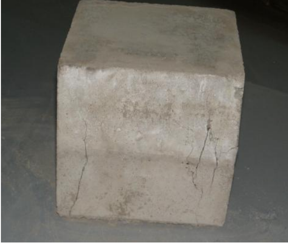
Şekil 4.13. Güçlü Dayanımlı Harca Ait Küp Numune Basınç Yüklemesi Sonrası Oluşan Çatlaklar (15x15cm)
