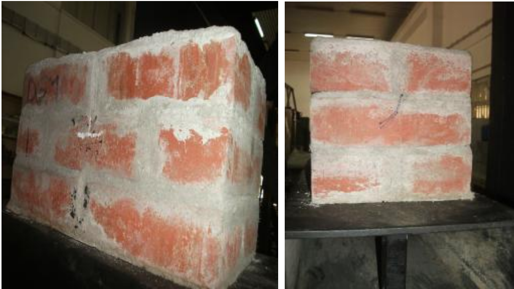
Şekil 4.103. Yükleme Sonrası DG1 Numunesinde Oluşan Çatlaklar
