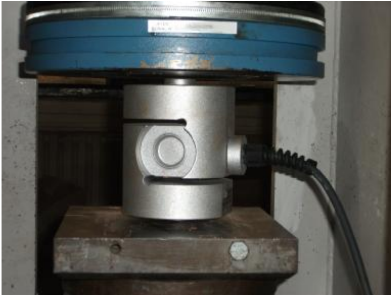
Şekil 4.20. Load Cell Kalibrasyon Düzenegi
