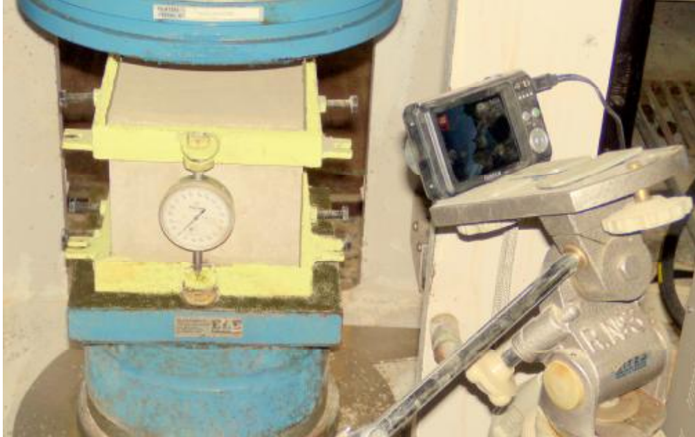
Şekil 4.10. Güçlü Dayanımlı Harca Ait Küp Numune (15x15cm)
