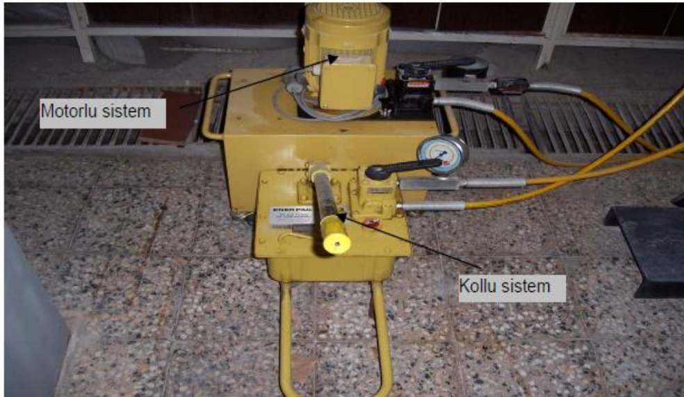
Şekil 4.32. Hidrolik Silindir Motorlu ve Kollu Yükleme Mekanizması
