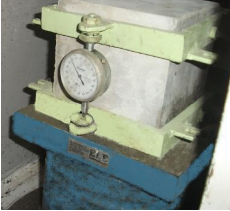
Şekil 4.6. Zayıf Dayanımlı Harca Ait Küp Numune (15x15cm)
