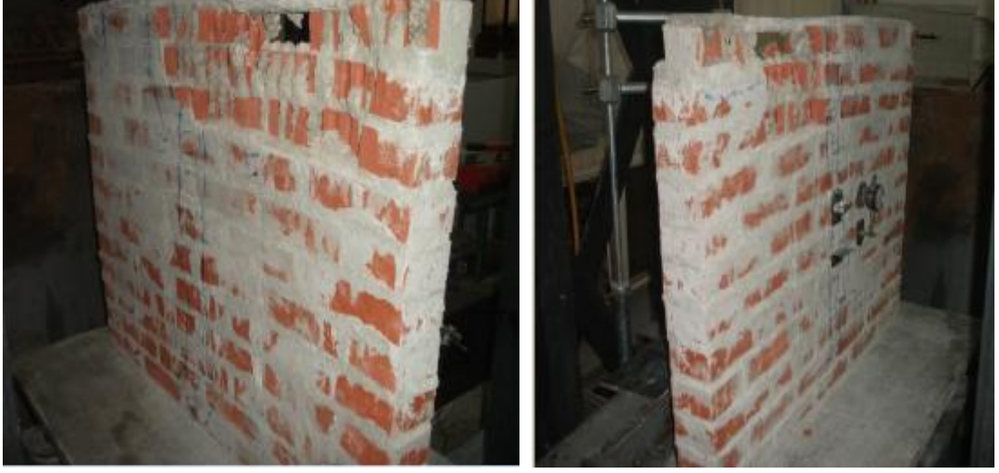
Sekil 4.74. Zayıf Harçlı 100x75 cm'lik Delikli Pres Tuğla Panel Numunesi (DPZ1) Yükleme Sonrası
