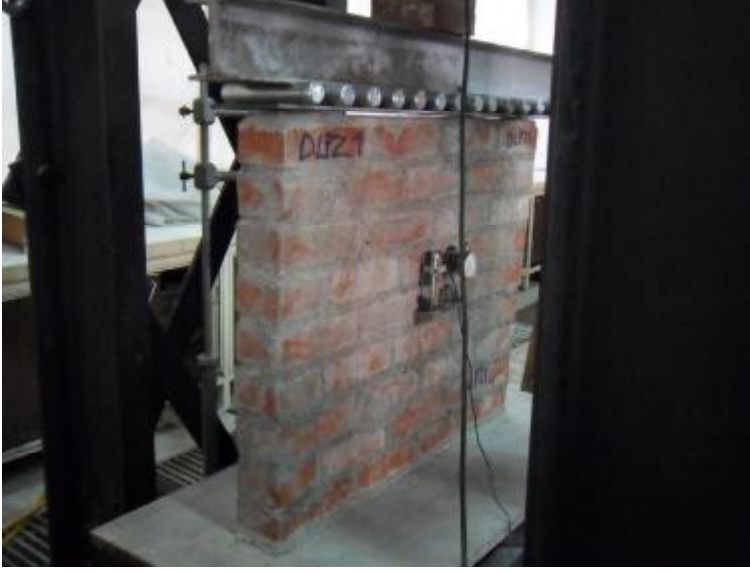
Sekil 4.76. Zayıf Harçlı 92 x 76 cm'lik Dolu Pres Tuğla Numunesi (DLPZ1) Yükleme Öncesi
