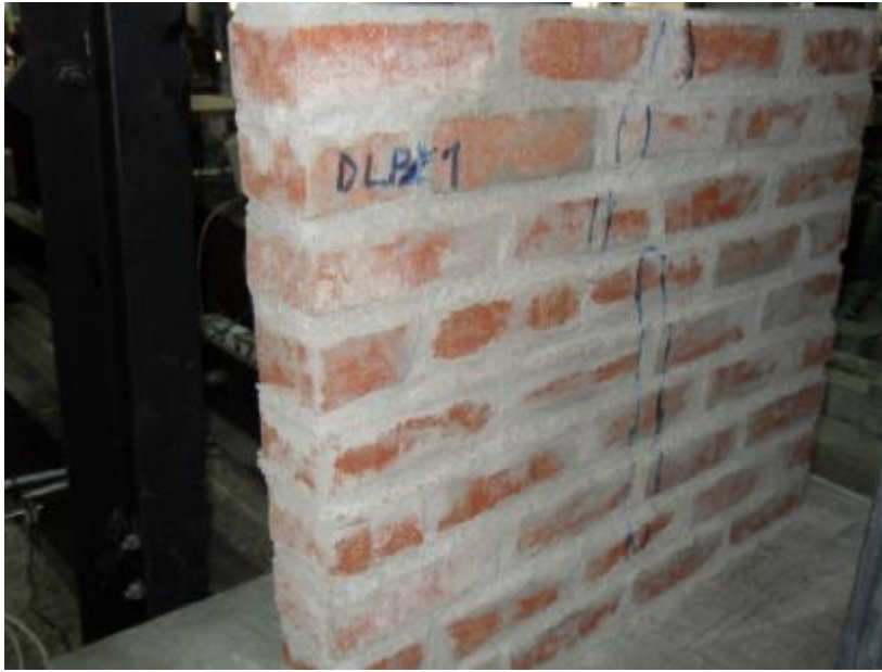
Sekil 4.80. Zayıf Harçlı 92x76 cm'lik Dolu Pres Tuğla Numunesi (DLPZ1) Yükleme Sonrası
