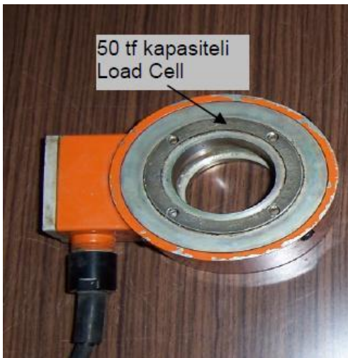
Şekil 4.18. 50 t Kapasiteli Load Cell (yük hücresi)
