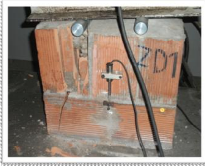
Şekil 4.33. Yatay Delikli Zayıf Harçlı 2 Sıralı Prizma Numunesi (ZD1)
