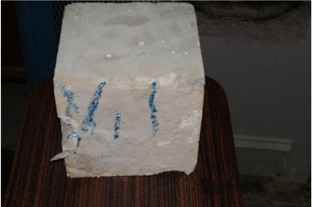
Şekil 4.7. Zayıf Dayanımlı Harca Ait Küp Numune Basınç Yükleme Sonrası Oluşan Çatlaklar (15x15cm)
