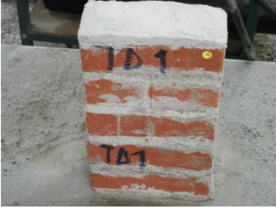
Sekil 4.107. TD1 Duvar Numunesi Göçme Anı ve Düşey Yönde Simetrik Oluşan Çatlaklar
