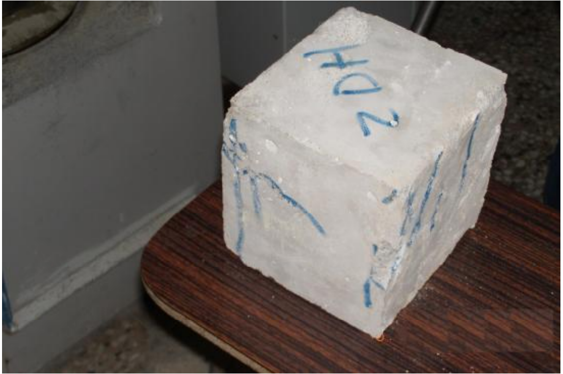
Şekil 4.8. Zayıf Dayanımlı Harca Ait Küp Numune Basınç Yüklemesi Sonrası Oluşan Çatlaklar (15x15cm)
