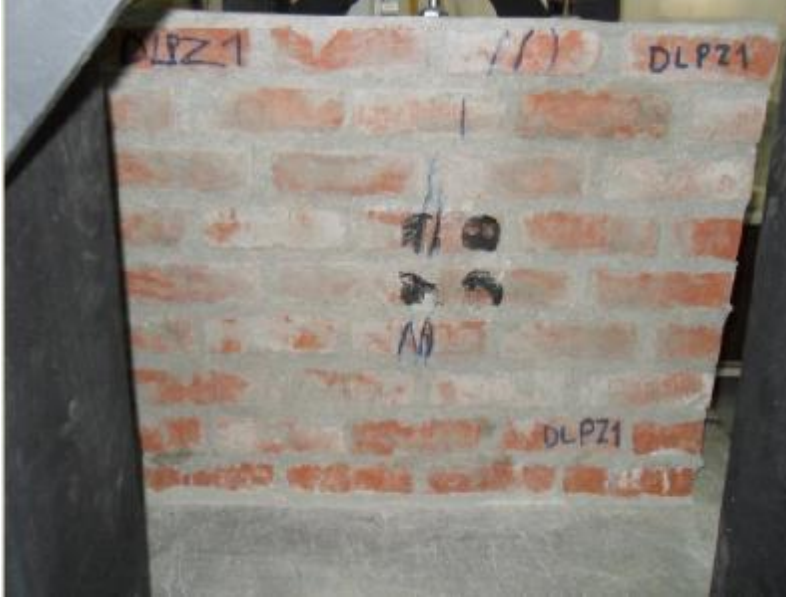
Sekil 4.79. Zayıf Harçlı 92x76 cm'lik Dolu Pres Tuğla Numunesi (DLPZ1) Yükleme Sonrası
