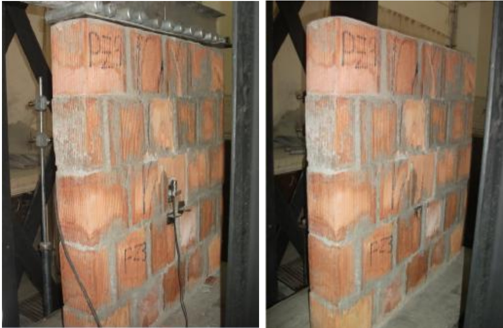
Sekil 4.68. Zayıf Harçlı 1x1m’lik Yatay Delikli Panel Numunesi (PZ3) Yükleme Öncesi ve Sonrası Görünümü.
