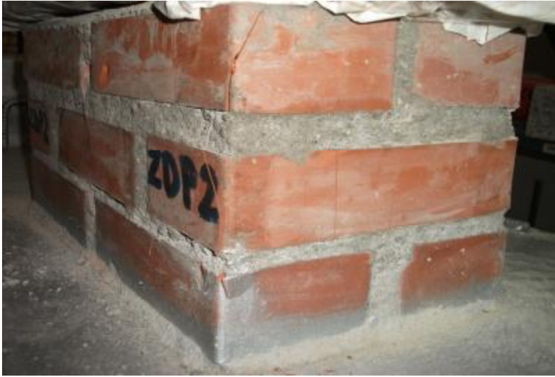
Sekil 4.45. ZDP2 Duvar Numunesi Göçme Anı ve Düşey Yönde Simetrik Olarak Oluşan Çatlaklar
