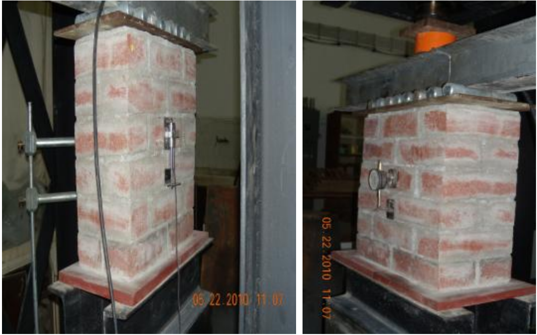
Sekil 4.97. Güçlü Harçlı Dolu Pres Tuğla Numunesi (DLGP1)
