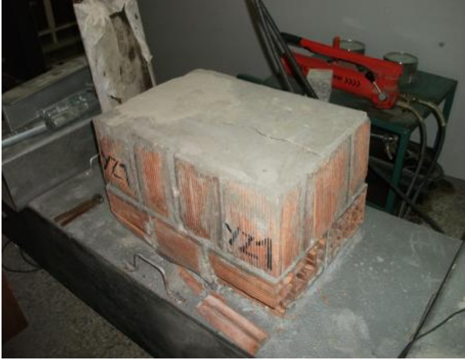
Şekil 4.36. Yatay Delikli Zayıf Harçlı 2 Sıralı 4'lü Prizma Numunesi (YZ1) Yükleme Sonrası Oluşan Çatlaklar.
