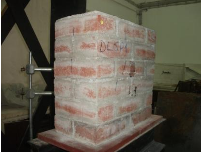
Şekil 4.100. Yükleme Sonrası DLGP1 Numunesinde Oluşan Çatlaklar (1)
