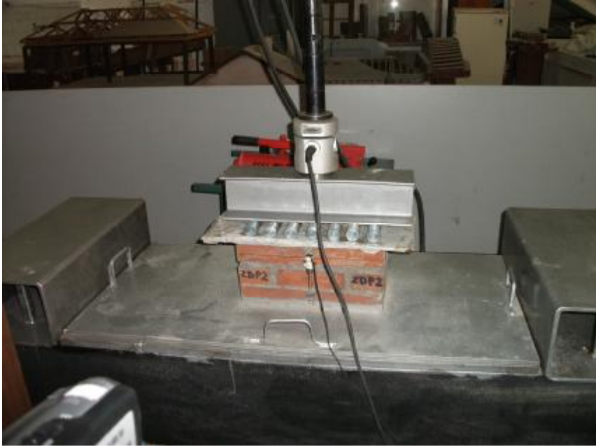
Şekil 4.42. Delikli Pres Tuğla Zayıf Harçlı 3 Sıralı 2'li Prizma Numunesi (ZDP2)
