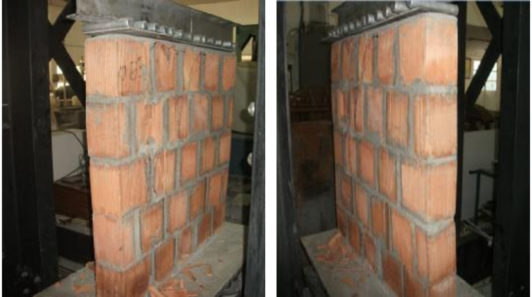
Sekil 4.62. Güçlü Harçlı 1x1m'lik Yatay Delikli Panel Numunesi Çatlak Oluşumları (PG3)
