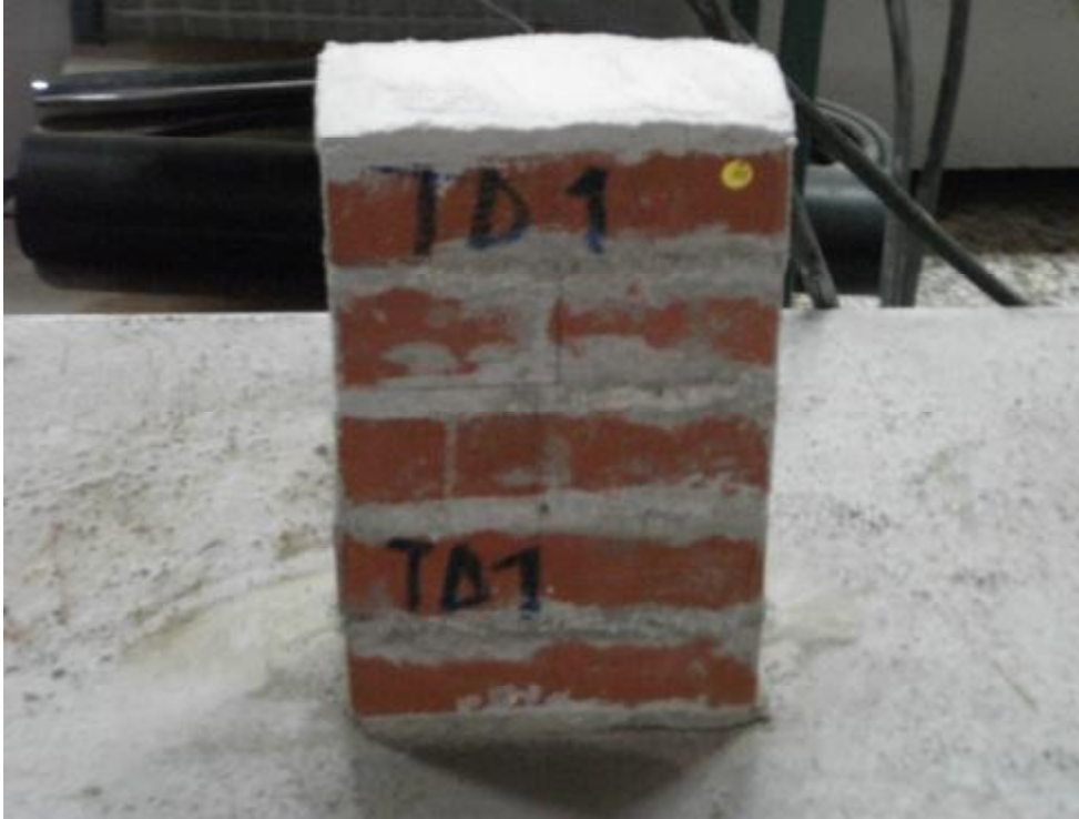
Şekil 4.49. Delikli Pres Tuğla Güçlü Harçlı Tekli 5 Sıra Duvar Numunesi (TD1)
