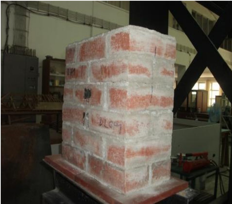
Şekil 4.101. Yükleme Sonrası DLGP1 Numunesinde Oluşan Çatlaklar (2)
