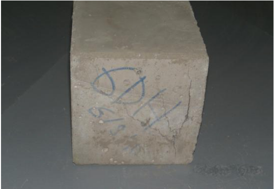
Şekil 4.12. Güçlü Dayanımlı Harca Ait Küp Numune Basınç Yüklemesi Sonrası Oluşan Çatlaklar (15x15cm)
