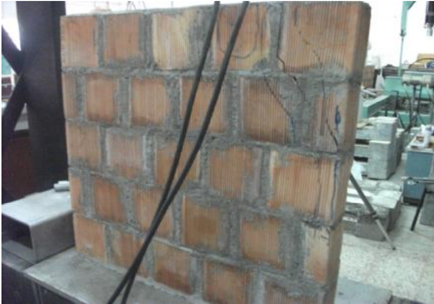
Sekil 4.56. PG2 Panel Numunesi Göçme Anı ve Düşey Yönde Oluşan Çatlaklar
