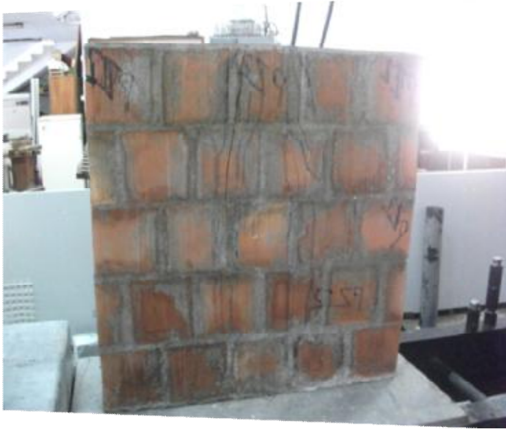
Sekil 4.65. Zayıf Harçlı 1x1m'lik Yatay Delikli Panel Numunesi (PZ2)
