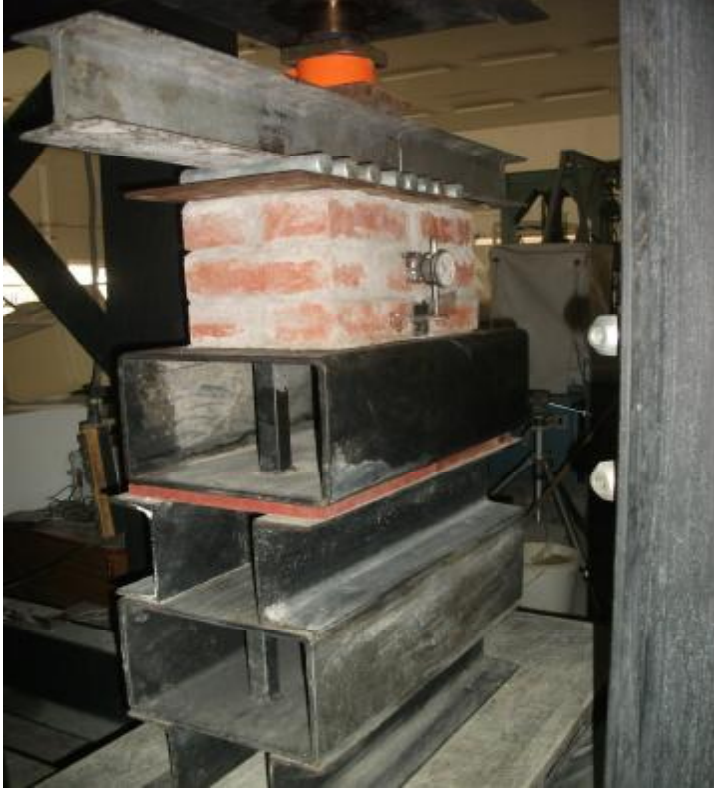
Şekil 4.102. Güçlü Harçlı 3 Sıralı Dolu Pres Tuğla Numunesi (DG1)
