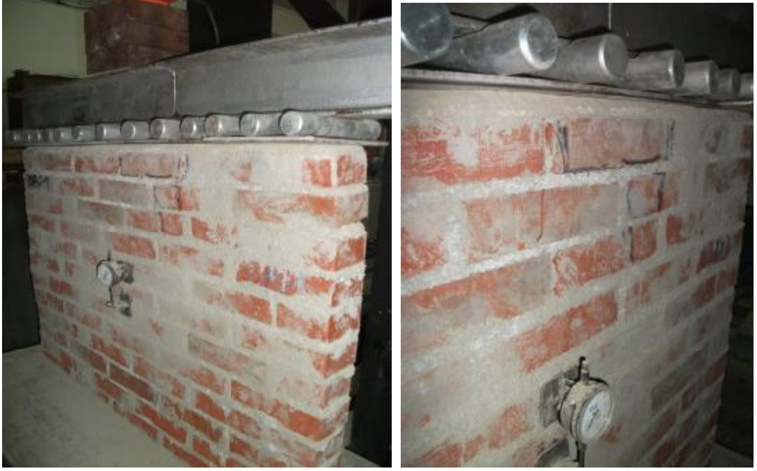
Şekil 4.95. Güçlü Harçlı 100 x 75 cm'lik Dolu Pres Tuğla Panel Numunesi Yükleme Sonrası Oluşan Çatlaklar
