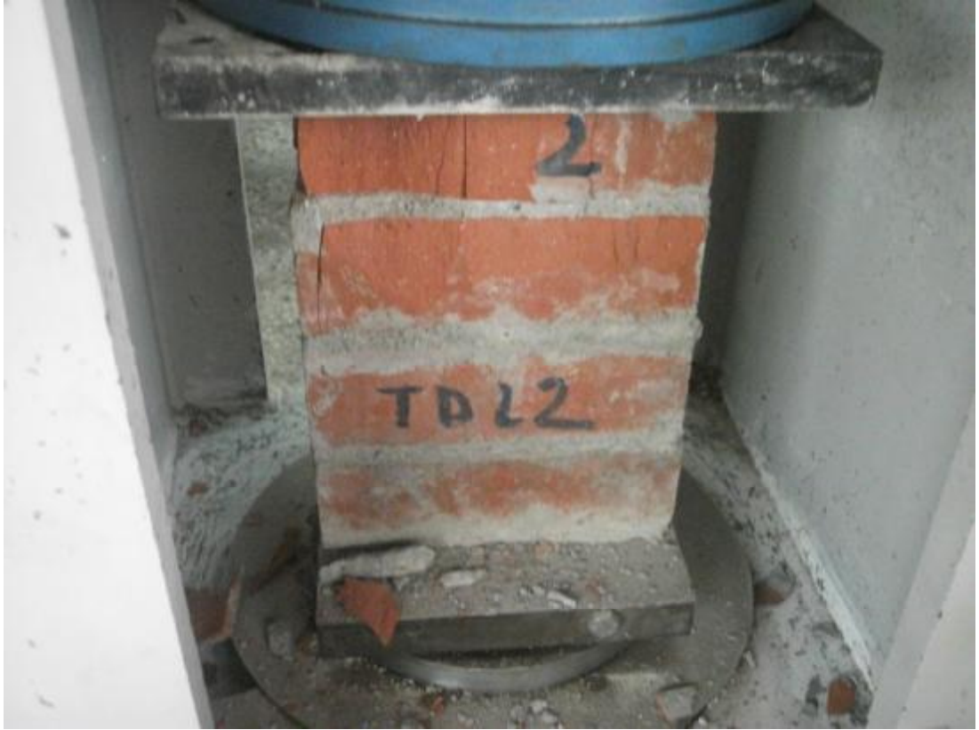
Sekil 4.88. Güçlü Harçlı Tekli 4 Sıralı Dolu Pres Tuğla Numunesi (TDL2) Yükleme Sonrası Oluşan Çatlaklar
