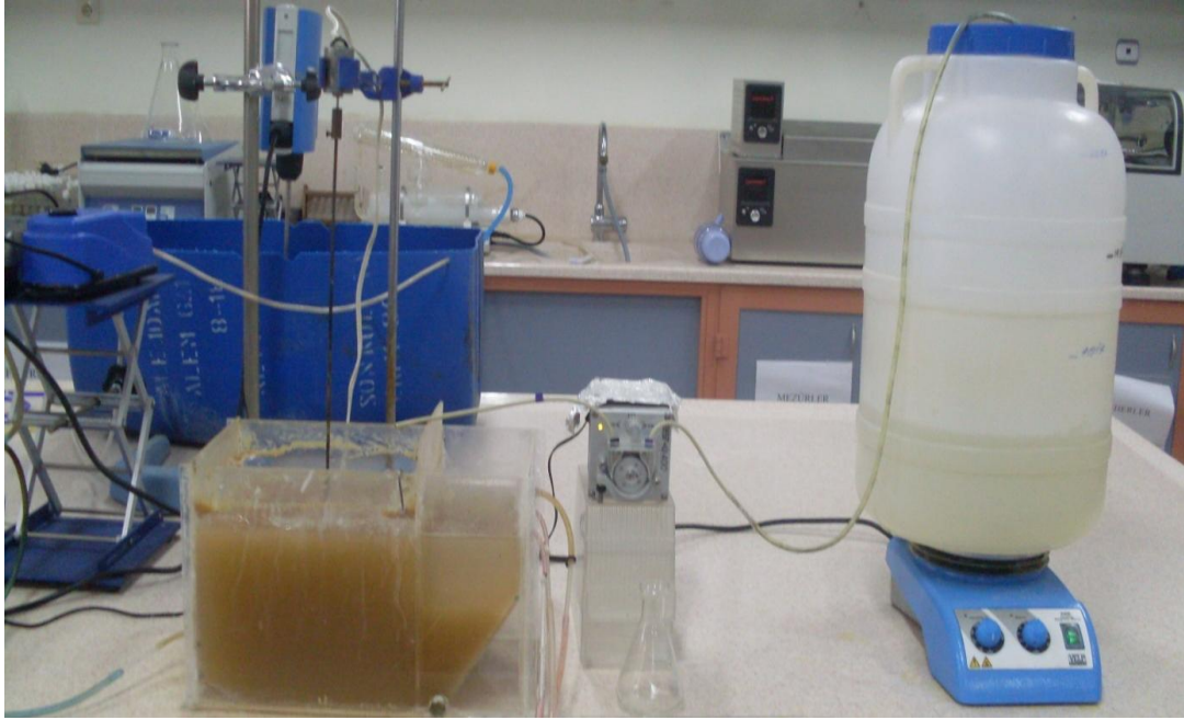
Şekil 3. 2. Sürekli karıştırılmalı tank reaktör besleme ve havalandırma
