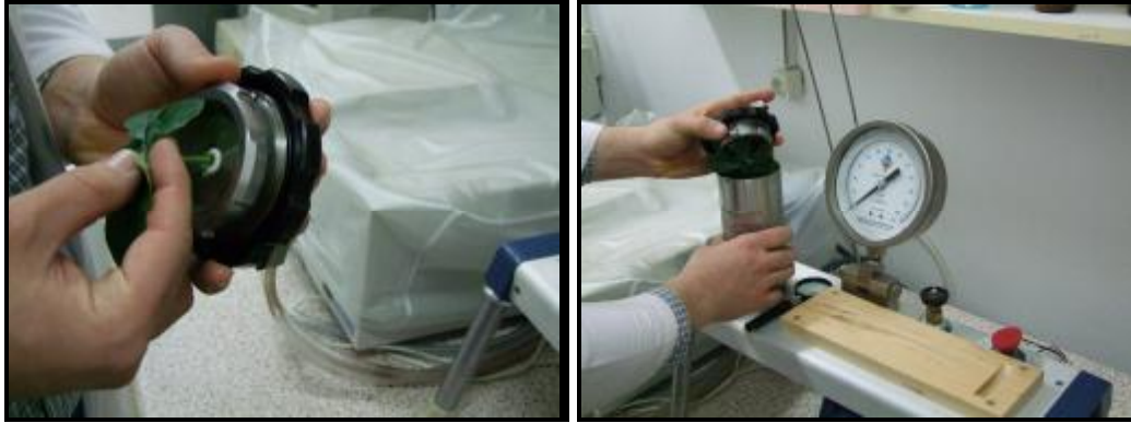
Şekil 3.7. Basınç çemberi ile bitki yaprak örneklerinde yaprak su potansiyelinin belirlenmesi
