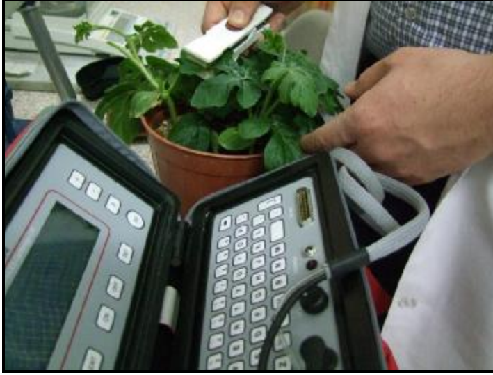
Şekil 3.10. Porometre ile stoma iletkenliğinin belirlenmesi
