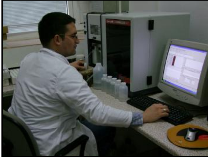
Şekil 3.6. Varian marka FS220 model atomik absorpsiyon spektrofotometre cihazında Na, K, Ca elementlerinin konsantrasyonlarının okunması
