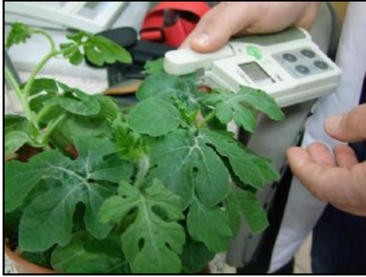
Şekil 3.5. Minolta marka SPAD klorofil metre ile klorofil okumalarının yapılması
