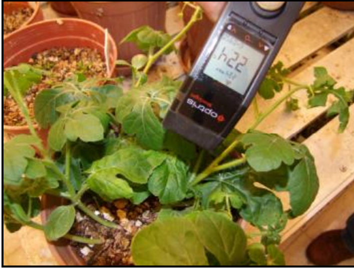
Şekil 3.9. Yaprak sıcaklığının infrared termometre yardımı ile ölçülmesi
