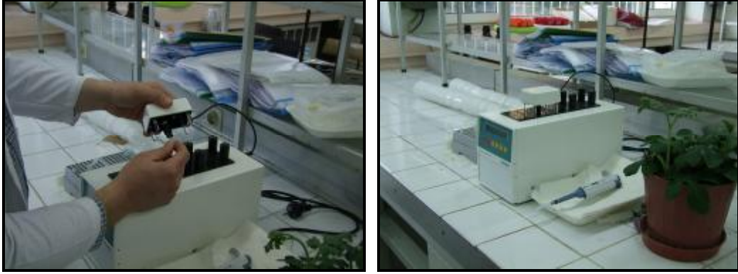
Şekil 3.8. Yaprak osmotik potansiyelinin osmometre cihazında okunması
