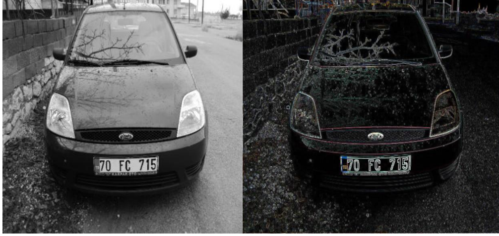
Şekil 5.6. Kameradan alınan ve Canny kenar bulma algoritması uygulanmış görüntü
