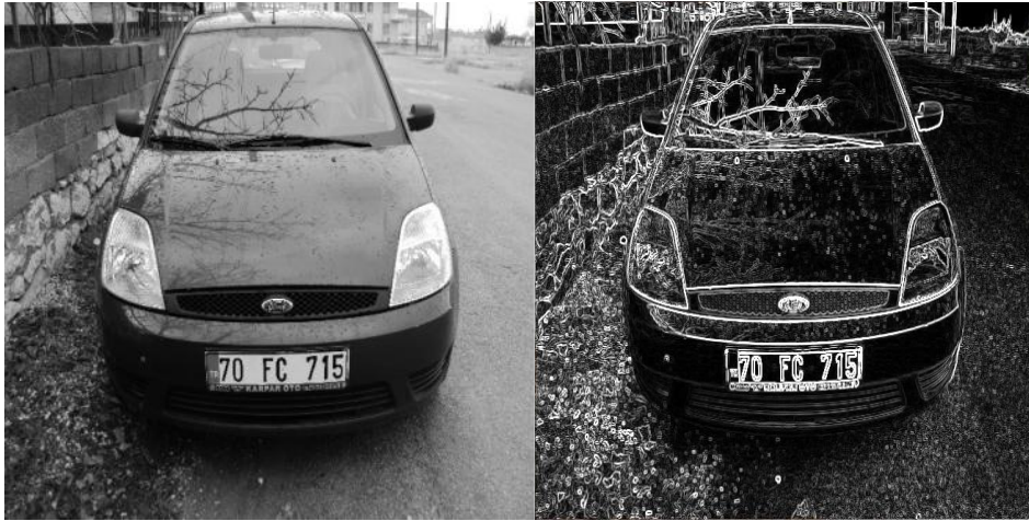
Şekil 5.3. Kameradan alınan ve Prewit kenar bulma algoritması uygulanmış görüntü
