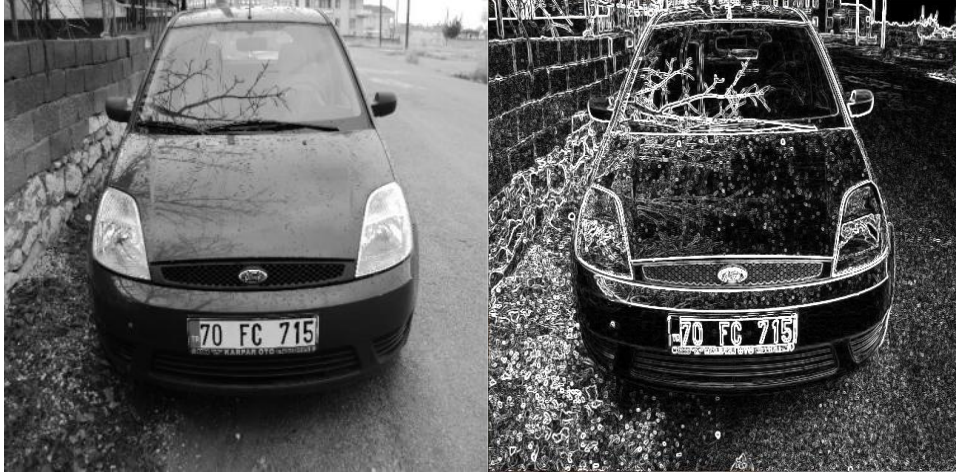
Şekil 5.2. Kameradan alınan ve Sobel kenar bulma algoritması uygulanmış görüntü
