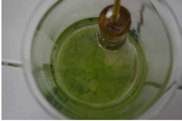
Fotoğraf 4.4 Gelişmeye başlayan oksijenik fotosentetik mikroorganizmaları içeren beherdeki test ortamının üstten görünüşü (14. gün)
