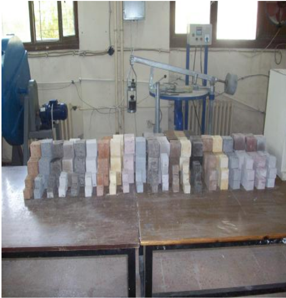
Şekil.3.3. Kayseri Bölgesinden alınarak fiziko-mekanik deneyler için hazır hale getirilen numunelerin görüntüsü
