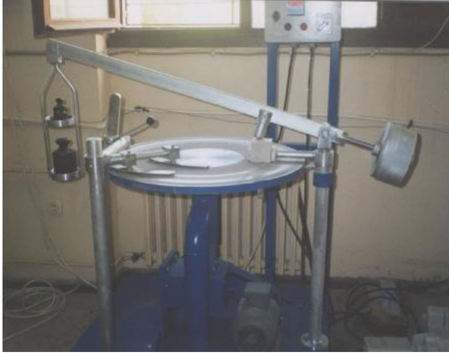
Şekil 3.8. Böhme yüzey aşındırma aleti
